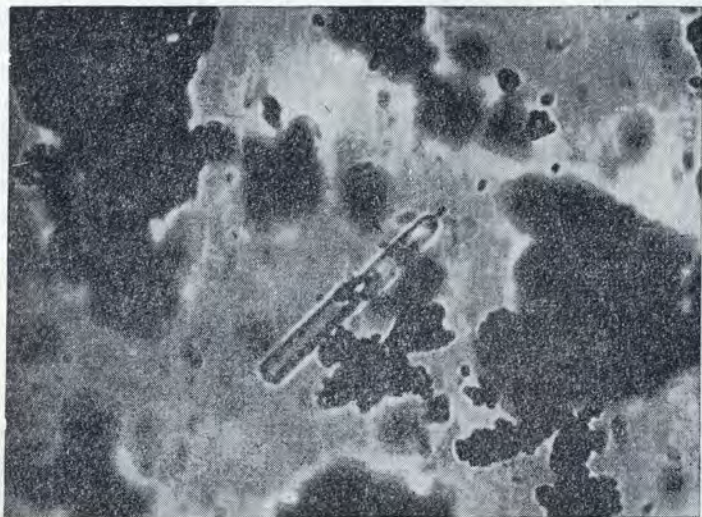
Рис. 34. Берилл из зоны взаимодействия высокотемпературных растворов, содержащих фторбериллат натрия, с микроклин-пертитом. \times 90
