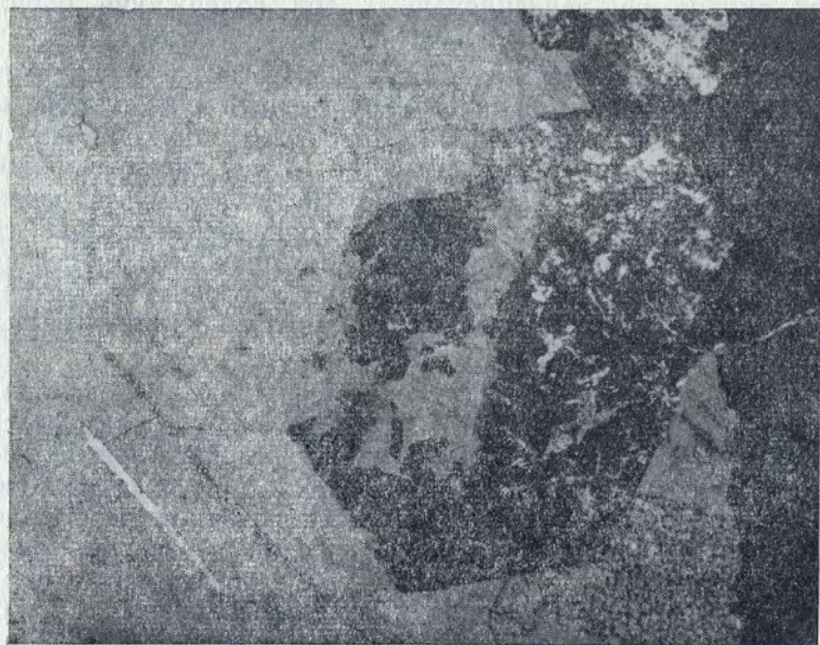
Рис. 13. Реликты плагиоклаза в кристалле берилла из апогранита. \times 25 (Забайкалье)
