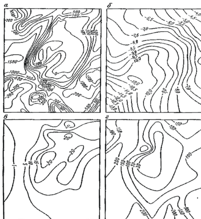
Рис.4.2. Геофизические поля над Бенкалинским меднопорфировым месторождением а – Z\alpha в нТл; б – -\Delta g в усл. Ед.; в – \eta_k в %; г – \rho_k в Ом м.
