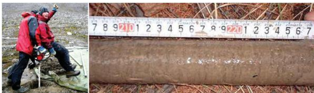
Рис. 7.16. Стефан Фогель (справа) и доктор Фрейзер Смит (слева) из Университета Данди на бурении вечной мерзлоты. Справа керн льдистого грунта из кровли вечной мерзлоты. Масштаб справа (см) указывает глубину от поверхности земли. Фото © Х. Х. Кристиансен и О. Хумлум
