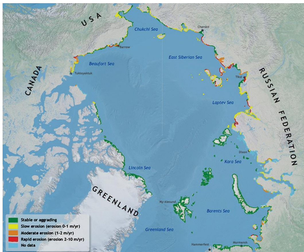
Рис. 11.27. Циркумполярная карта скорости термоэрозии (по Lantuit, Overduin, et al. , 2012, Рис. 7). Обратите внимание на высокую изменчивость, причем некоторые области, по существу, являются стабильными или аградирующими (stable or aggrading): медленная абразия (slow erosion), умеренная абразия (moderate erosion), быстрая абразия (rapid erosion)
