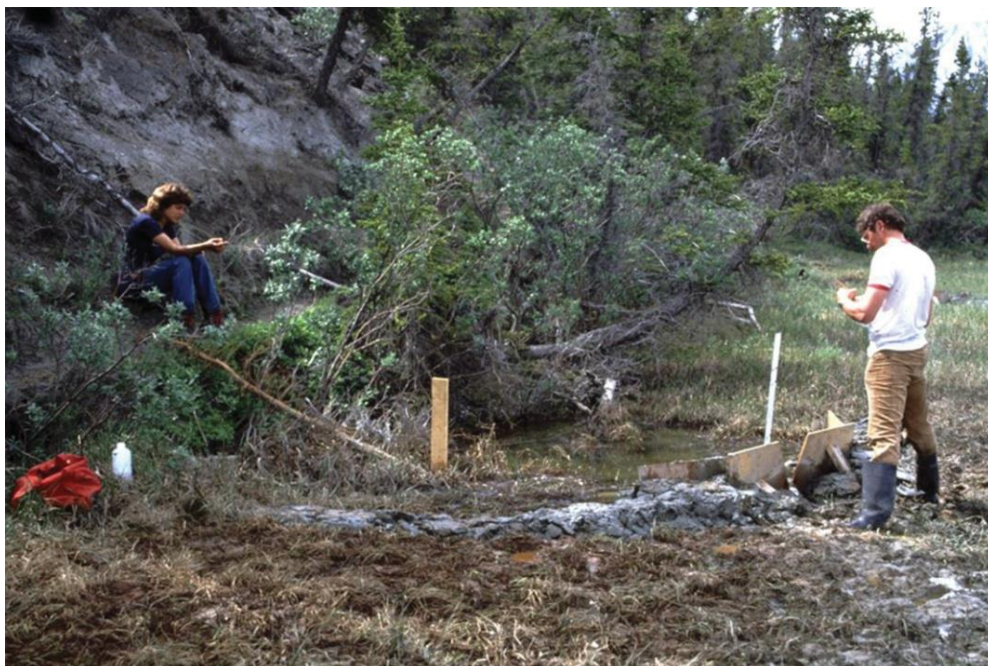
Рис. 9.23. Измерение потока воды у источника в передней части каменного глетчера Ист Слимс, Юкон. © S. A. Harris
