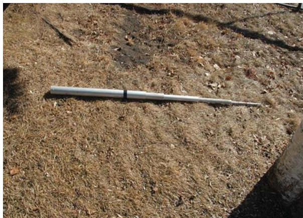
Рис. 2.21. Телескопические вложенные стержни, которые могут использоваться для измерения дифференциального пучения и деформаций в поверхностных слоях горных пород активного слоя. Они размещаются в вертикальном отверстии с черной меткой на поверхности горных пород. Стержни движутся вертикально вместе со слоем горных пород, с которым они контактируют
