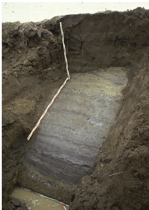
Рис. 1.1. Типичный разрез с льдистыми породами ниже слоя сезонного оттаивания (активного слоя) 72 см (Мохалла, Исландия). Обратите внимание на концентрацию льда в поверхностных слоях, при этом льдистость уменьшается с глубиной. © S. A. Harris
