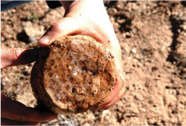
Рис. 7.17. Сегрегационный лёд в глинисто-песчаных и галечных осадках в литальсе, 35 °01 N, 97 ° 34 E на высоте 4310 м на восточном склоне плато Цинхай-Тибет. © S. A. Harris
