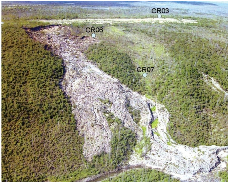
Рис. 8.33. Полициклические оплывины при оттаивании: новые частично развиваются в стабилизированных ранее. Из Singhroy et al. (2010, Рис. 3)
