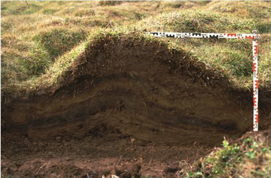
Рис. 7.39. Разрез одного из туфуров, показанных на рис. 7.38. Обратите внимание на утолщение темных, илистых прослоев под кочкой. Принятой причиной утолщения является движение воды на неровный, движущийся вниз фронт промерзания, несущей с собой более мелкие частицы (внизу справа). Эти частицы накапливаются там, где вода превращается в лёд, и остаются там, когда лёд тает (см. рис. 7.40). © S. A. Harris
