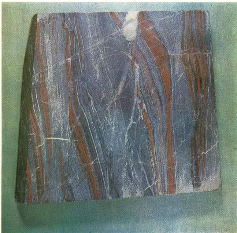
Тектонически нарушенная плоскопараллельная полосчатость в железистом кварците. Кривбасс, шестой железистый горизонт
