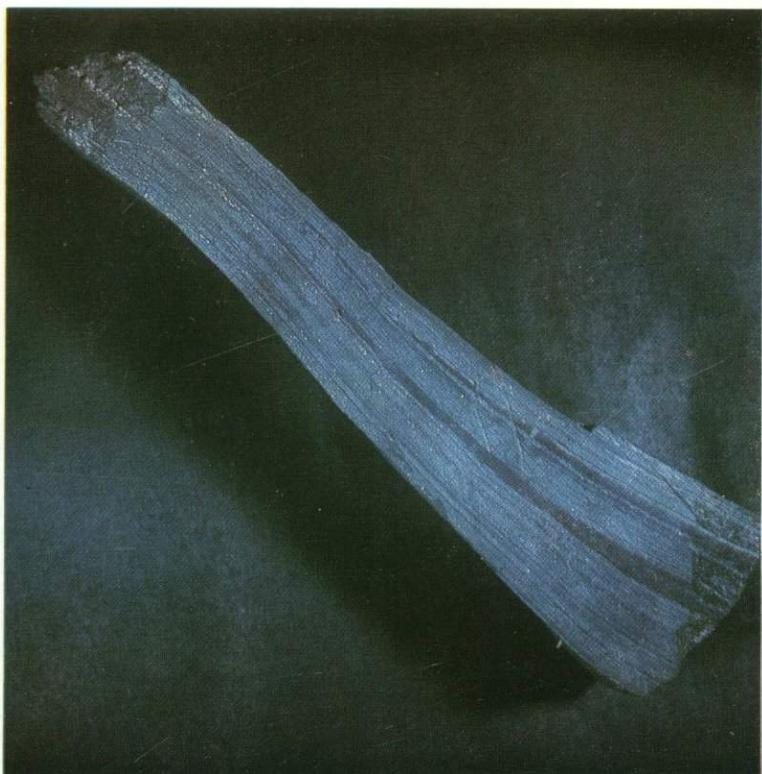
Уменьшение мощности джеспилита при переходе его в руду за счет постепенного выклинивания гематит-кварцевых прослоев. Кривбасс, рудник им. Дзержинского, пятый железистый горизонт
