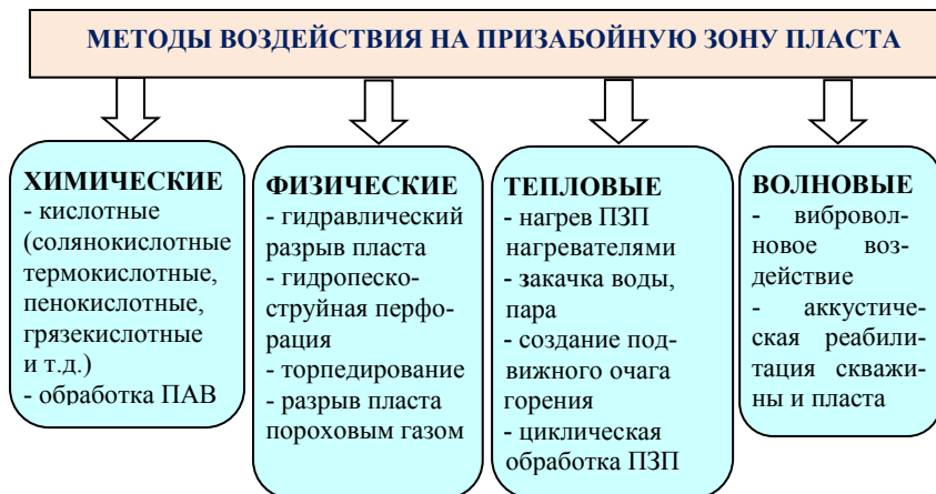
Рисунок 8.3. Классификация методов воздействия на ПЗП
