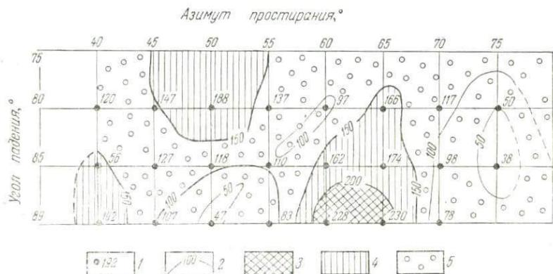
Рис. 57. Диаграмма распределения оруденения в поле элементов залегания в Новой рудной зоне
