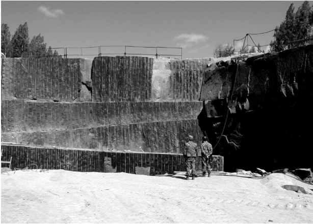
Рис. 4. Основные системы трещин на месторождениях габбродолеритов Восход (слева) и Авнепорог (справа)
