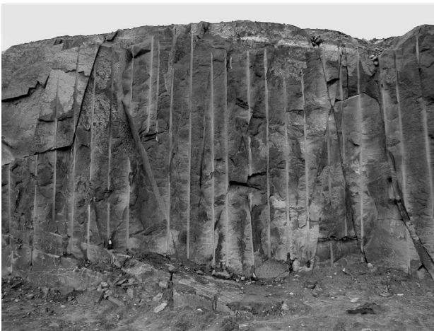
Рис. 6. Основные системы трещин на месторождении габброноритов Северный Кейносет (а) и круговая диаграмма трещиноватости (б) (количество замеров 211, равноплощадная проекция, верхняя полусфера)
