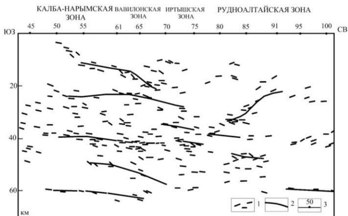
1 – отражающие сейсмические площадки; 2 – предполагаемые сейсмические границы раздела; 3 – местоположение и номер сейсмического профиля.
