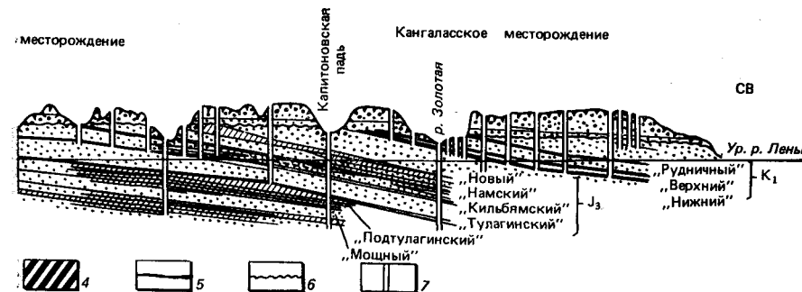
буроугольных месторождений (по Н. А. Игнатченко): 1 — пески с гравием и галькой; 2 — песчаники и пески; 3 — алевролиты и глина в зоне размыва; 4 — углистые алевролиты и глины; 5 — пласты угля; 6 — поверхность; 7 — скважины.
