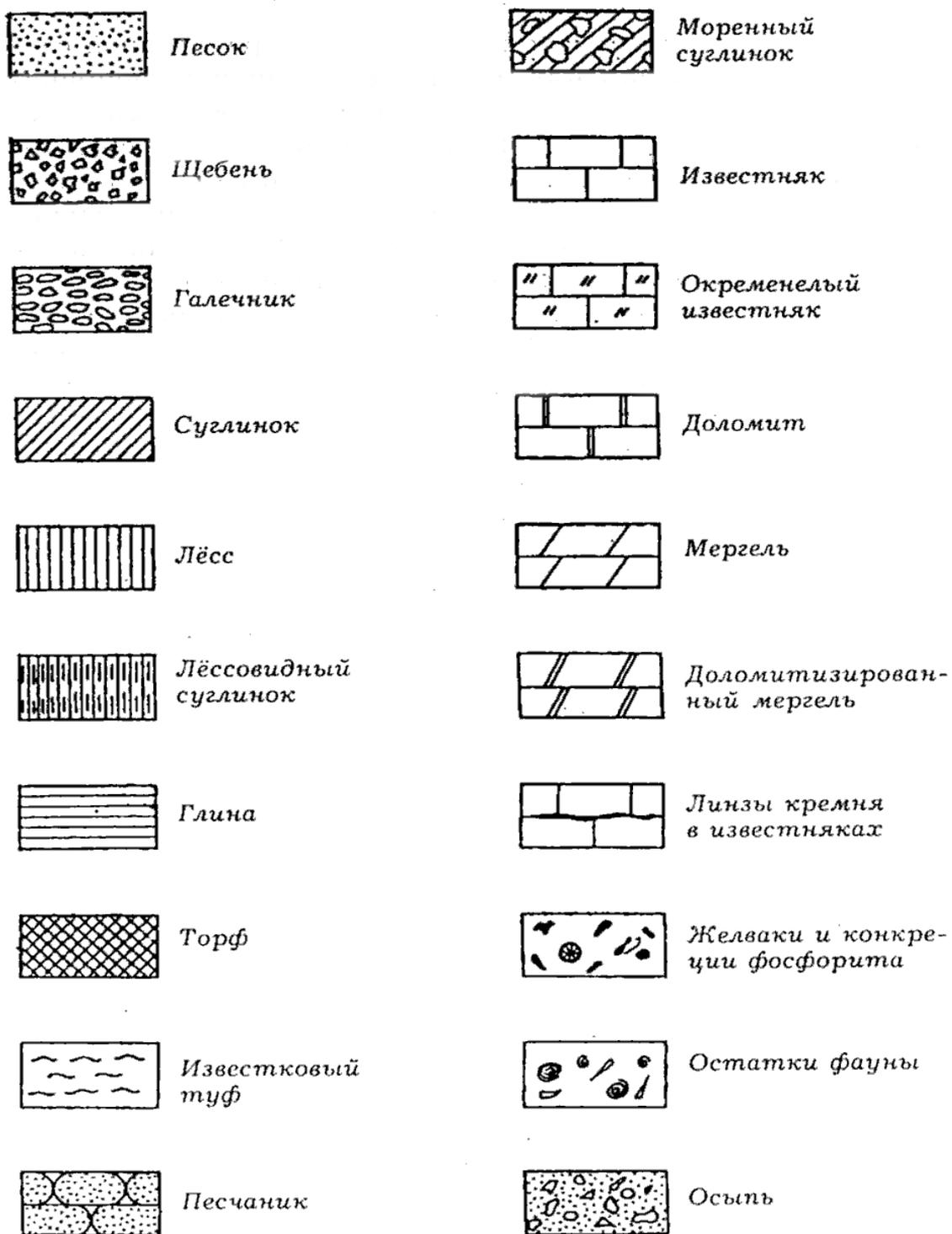
Рис. 4.4. Примерные условные обозначения литологического состава осадочных горных пород на картах и в разрезах
