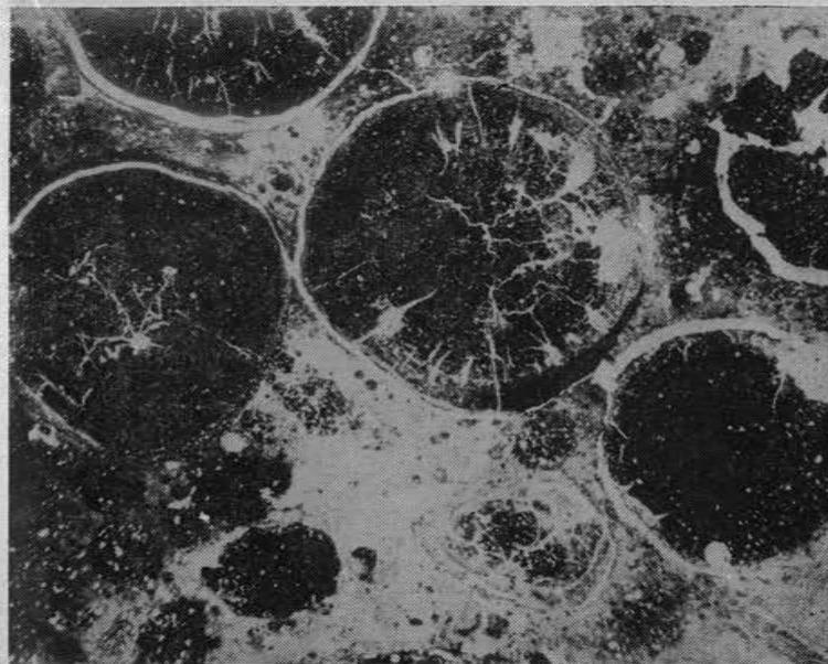
Рис. 4. Трещины усыхания в бобовом боксите (шлиф, увеличение 5, николи параллельны)
