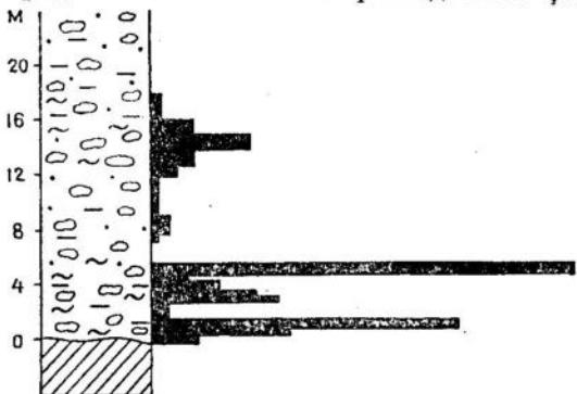
Рис. 35. Распределение золота в вертикальном разрезе россыпи днища ручья Болотного (условные обозначения см. на рис. 34).
