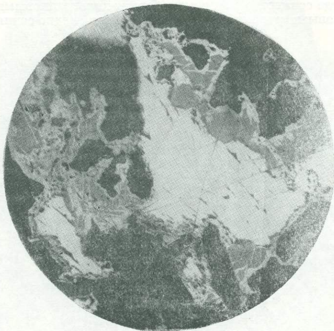
Рис. 54. В прожилке кальцита галенит (белый) замещается борнитом (темно-серый). Борнит, в свою очередь, замещается более поздним халькопиритом, образующим каемки и пластинки. \times 90 , шл. 737, залежь Покро-3-I.
