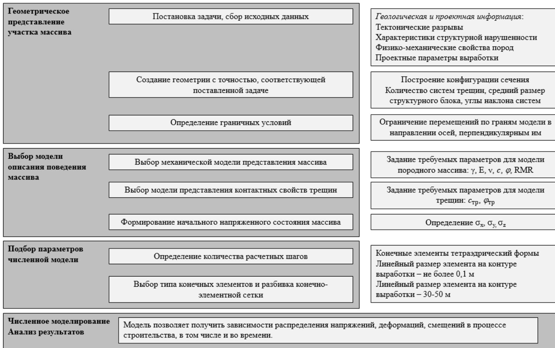
Рисунок 2.20 – Порядок создания численной модели
