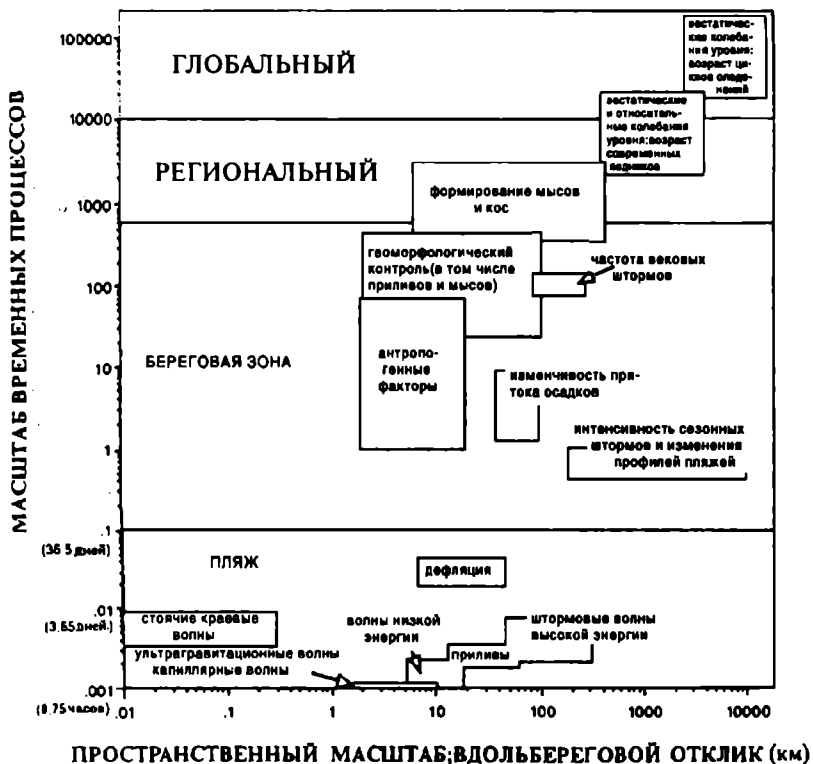
Рис.2. Временные и пространственные масштабы береговых изменений (Fenster, Dolan, 1993). Каждый прямоугольник отражает пространственное (вдольбереговое) воздействие различных процессов или антропогенных факторов, ответственных за перемещение береговой линии, и длительность этих процессов.
