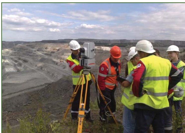
Маркшейдеры ОАО «Карельский окатыш» знакомятся с работой сканера Leica HDS8800
