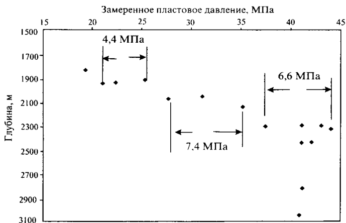
Рис. 7.21. Харасавейская структура. Перепад измеренных пластовых давлений в горизонтальной плоскости (К)
