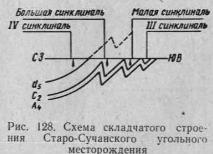
Рис. 128. Схема складчатого строения Старо-Сучанского угольного месторождения
