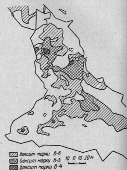
Рис. 191. Распределение марок боксита по данным эксплуатационной разведки на участке, представленном на рис. 190
