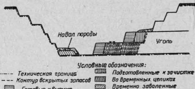
Рис. 239. Открытая разработка горизонтального пласта
