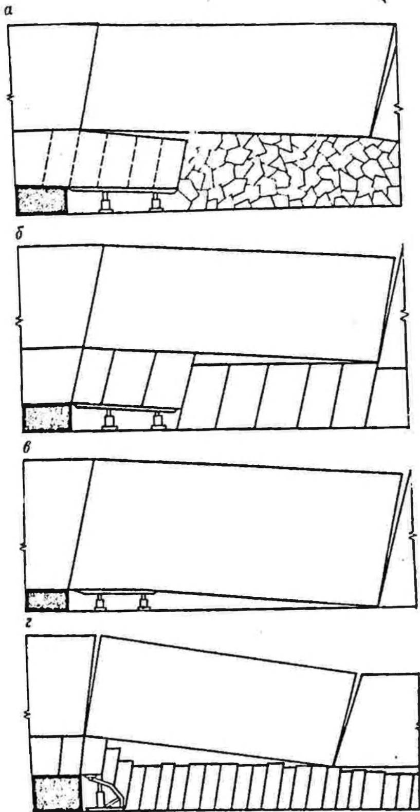
**Рис. 8. Схемы разрушения кровли над крепью при осадках труднообрушающихся пород при применении крепей:**
