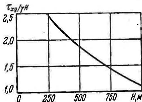
Рис. 2. Изменение коэффициента концентрации касательных напряжений с увеличением глубины разработки
