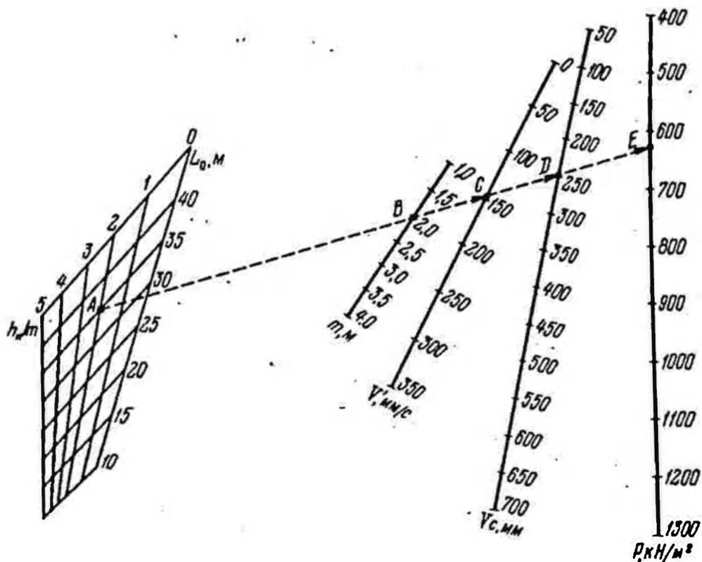
Рис. 19. Номограмма для определения параметров крепи
