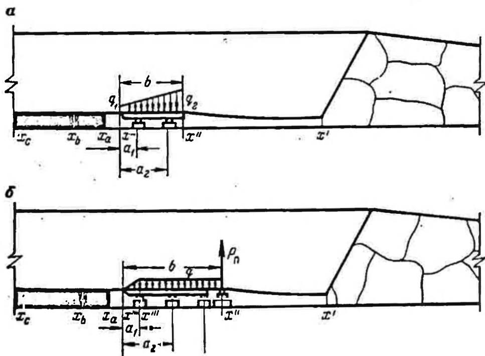
Рис. 10. Расчетные схемы для определения влияния сопротивления крепи на напряженное состояние кровли:
