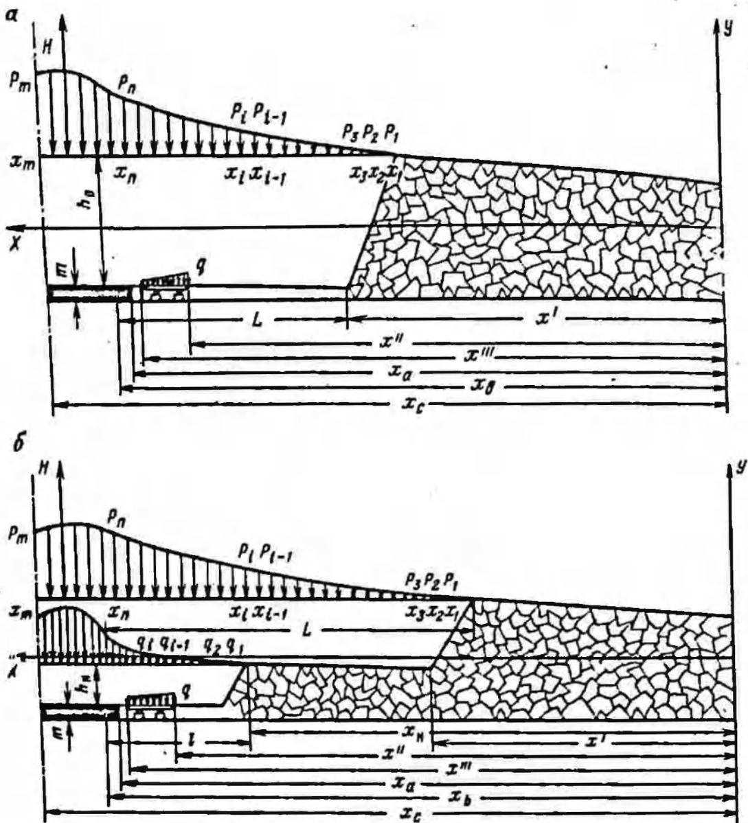
Рис. 9. Расчетная схема для определения напряженно-деформированного состояния кровли в периоды между осадками труднообрушающихся пород:
