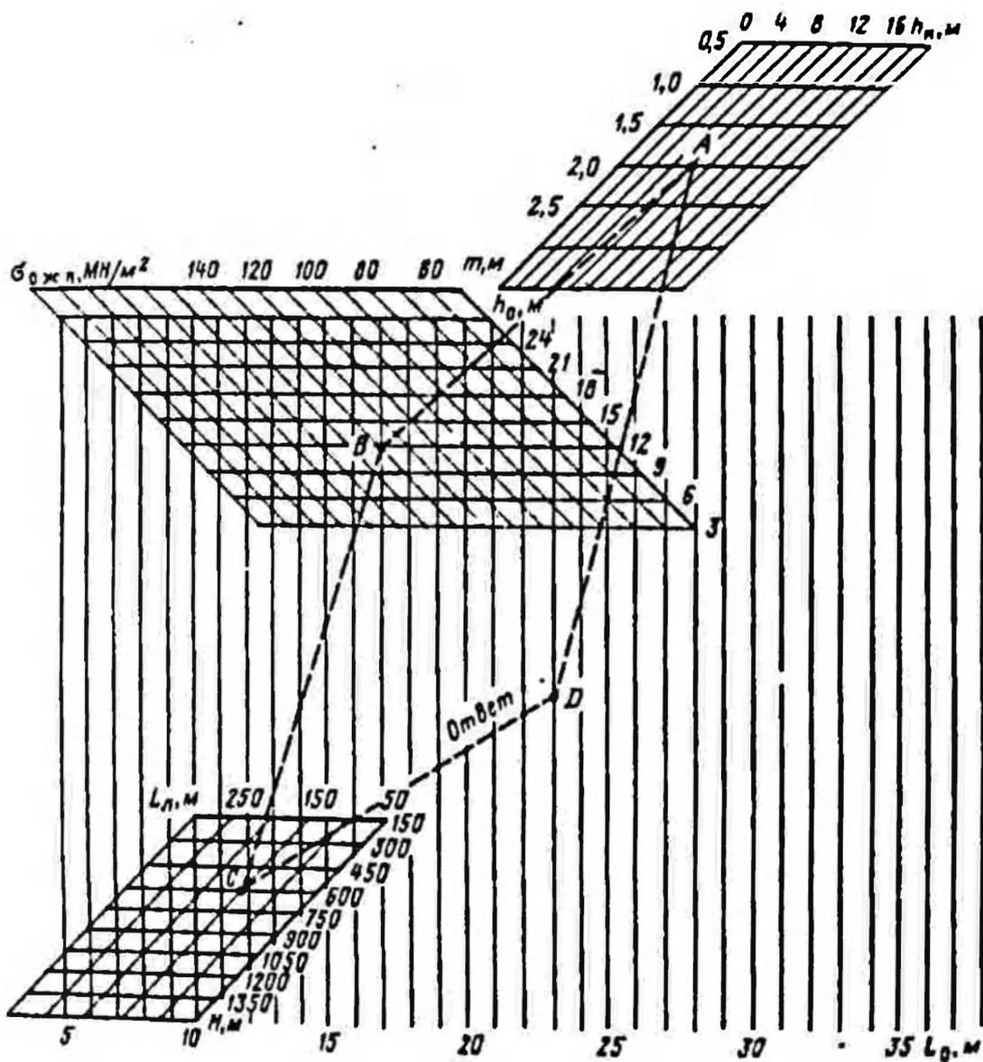
Рис. 20. Номограмма для определения шага обрушения кровли
