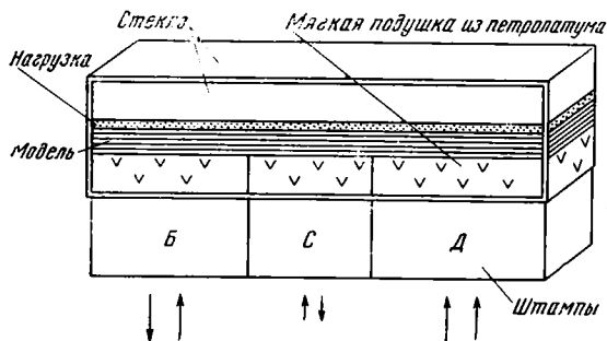
Рис. 3. Прибор для моделирования сочленения складчатых зон
