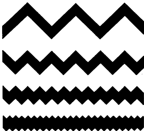
Рис. 3. Различные формы складчатого залегания пластов одинаковой мощности ( M ), но с разной амплитудой складок ( A ) a - A=3M ; b - A=2M ; в - A=M ; г - A=0,5M
