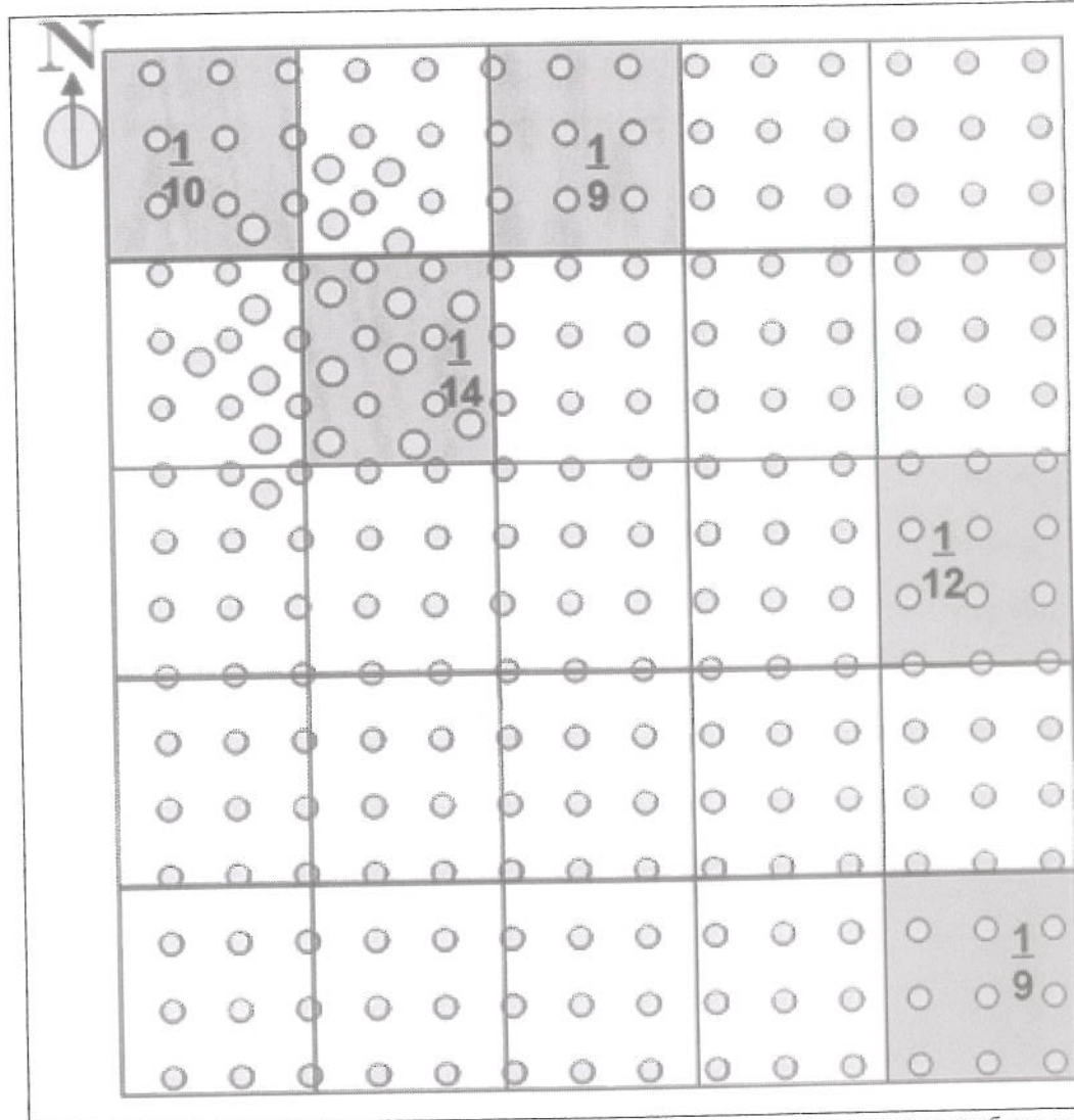
Рис. 81 Метод декластеризации 3: взвешивание проб относительно числа всех проб внутри одной ячейки (показаны пять примеров ячеек с взвешенными пробами)
