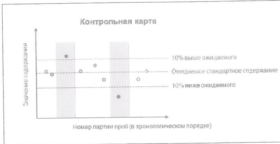
Рис. 30 Пример лабораторных данных по двум контрольным пробам с содержаниями, выходящим за \pm 10\% контрольные границы
