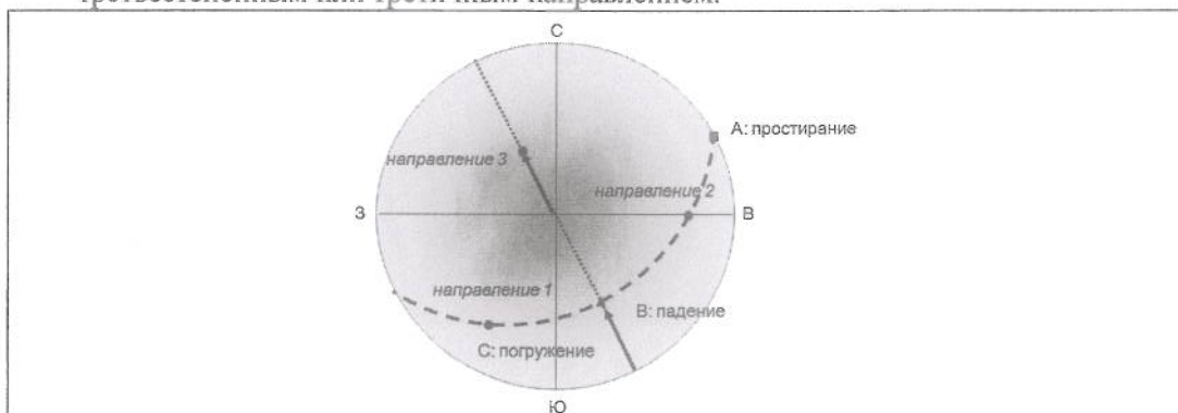
Рис. 107 Схематическая стереопроекция важнейших направлений вариограммы
