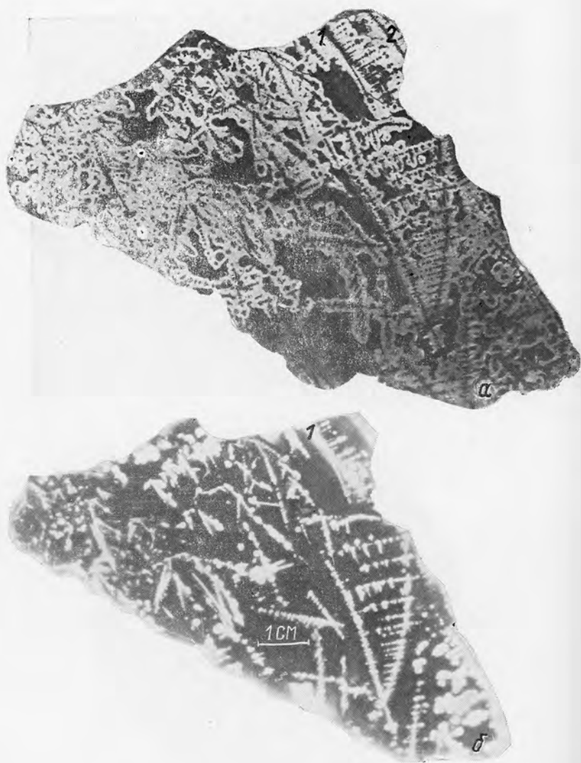
Рис. 6.20. Дендритовая структура. Образование настурана (1) дендритов самородного серебра в раммельсбергите (2): а — фото образца; б — радиография образца
