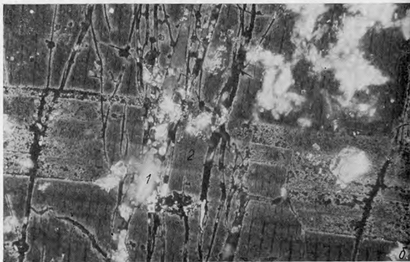
Рис. 6.8. Образование островков реакционной пленки сульфата свинца на настуране с H_0=700+780 \text{ кг/м}^2 и H_1=600 \text{ кг/м}^2 (микрофото аншлифа, обр. 6708):
