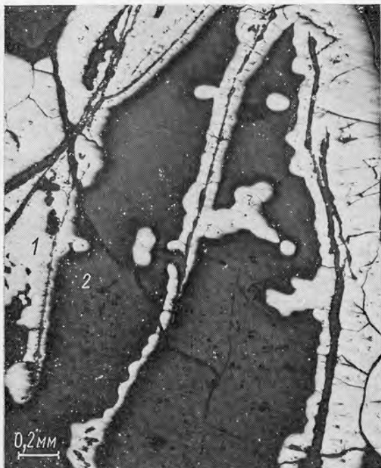
Рис. 3.10. Метасферолиты регенерированного настурана (1) в кальците (2) (см. табл. 3.1, обр. Л-49а; микрофото аншлифа)
