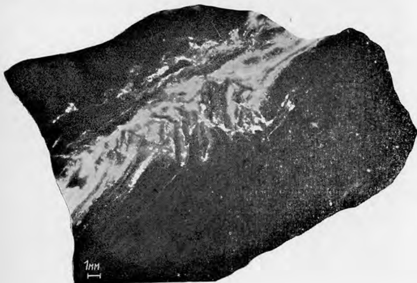
Рис. 5.9. Характер распределения урановых минералов в катаклазированных породах (радиография образца)
