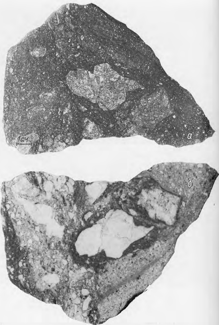
Рис. 5.39. Брекчиевидная текстура браннеритовой руды: a — фото образца; б — радиография
