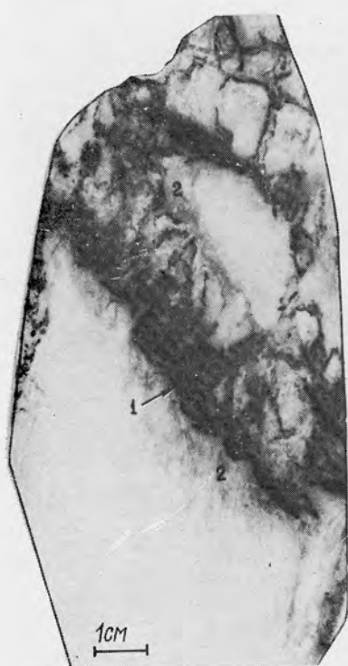
Рис. 4.28. Руды брекчиевой текстуры (радиографии штуфа):
