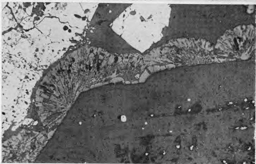
Рис. 3.23. Сложные дендриты диарсенидов никеля и кобальта в карбонатной жиле (фото аншлифа)
