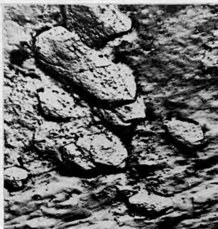
Рис. 1.13. Минераграфические признаки ориентировки зерен синтетических и природных окислов урана (видны ямки травления на полированной поверхности спеченной двуокиси урана)
