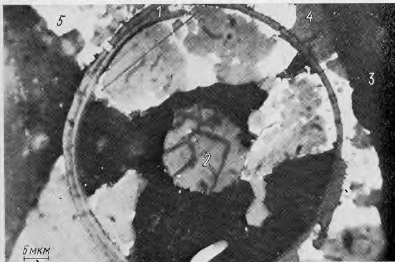
Рис. 6.2. Электронное микрофото стенки трещины в наустране, выполненной кальцитом. Видны отпечатки вершин основных ромбоэдров, свидетельствующие о метасоматической природе границ (целлюлозо-угольная реплика)
