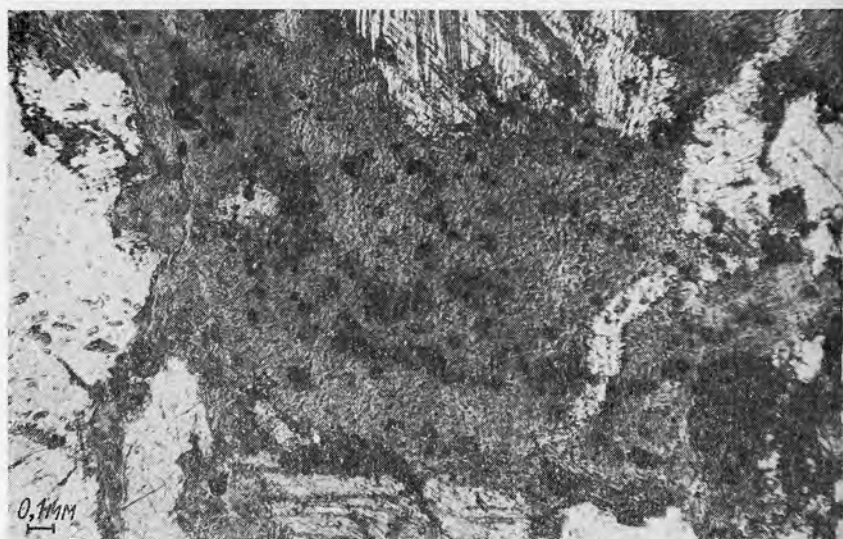
Рис. 5.34. Цементация и нарастание настурана (1) на зерна альбита (2) (3 — включения галенита; микрофото аншлифа)
