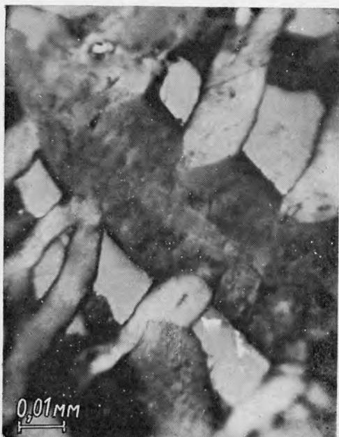
Рис. 4.37. Микропрожилки твердого битума, цементирующие обломки настурана (светло-серые). Микрофото шлифа в поляризованном свете, иммерсия)
