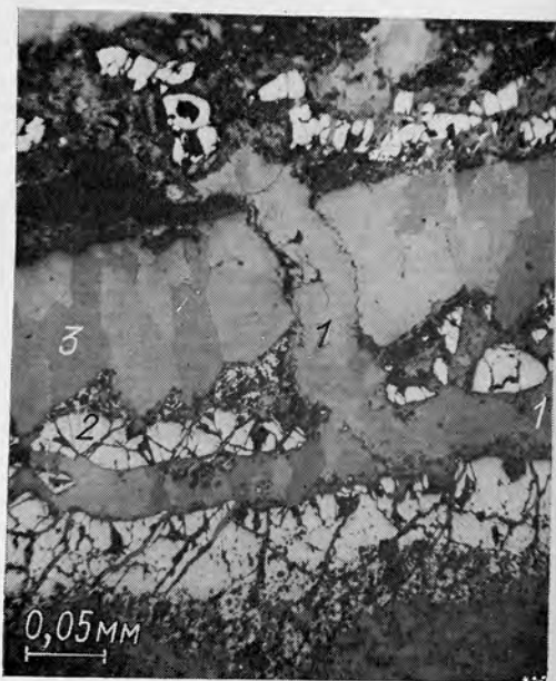
Рис. 4.32. Текстуры пересечения ранних кристаллических выделений карбоната (1) и корок молибденит-настуранового агрегата (2), настураном второй генерации (3) с хлоритом (4) и поздним карбонатом (5). Микрофото аншлифа
