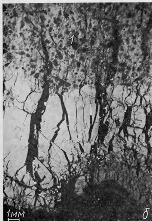
Рис. 4.43. Развитие настурана IV в карбонате (а) и настуране I—II (б) (микрофото аншлифа):
