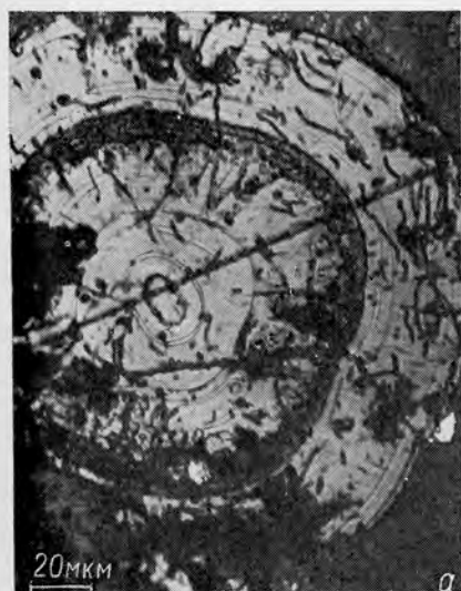
Рис. 1.3. Скелетные (открытые) сферокристаллы коффинита на сферокристаллической корке (закрытые сферолиты) настурана (Рудные горы):
