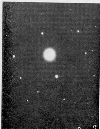
Рис. 1.20. Дендриты неопределенного минерала в изотропизированном коф- фините (обр. В. В. Казанцева). Электронное микрофото
