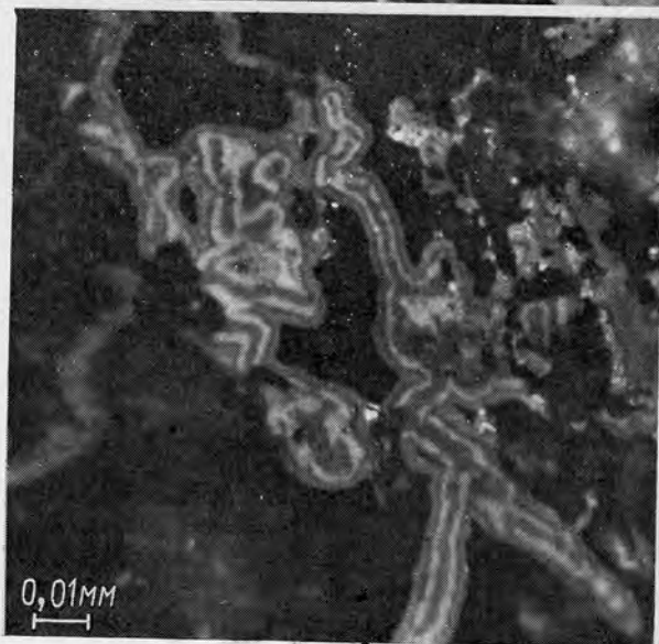
Рис. 4.11. Почковидные корки настурана III с включениями (одновременное отложение) иордизита в приповерхностной зоне сферолитов (микрофото аншлифа) 1 — настуран; 2 — иордизит; 3 — кальцит; 4 — пирит
