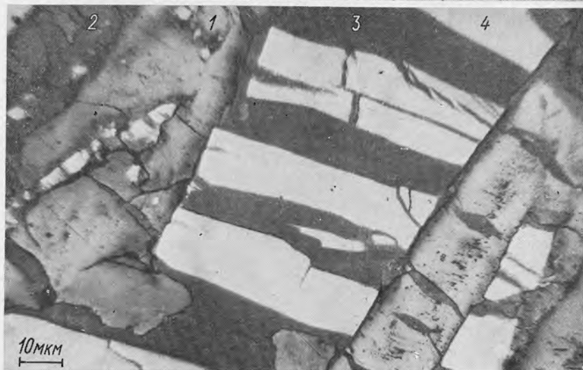
Рис. 3.12. Периодическое чередование корок настурана (1) и корок коффинита (псевдоморфозы с включениями сферокристаллов настурана и окислов урана с низким отражением) (2). Микрофото аншлифа
