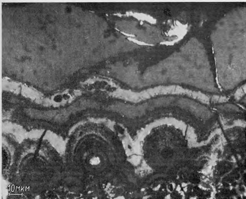
Рис. 4.9. Колломорфно-зональное строение корки крупносферолитового настурана III (микрофото аншлифа)
