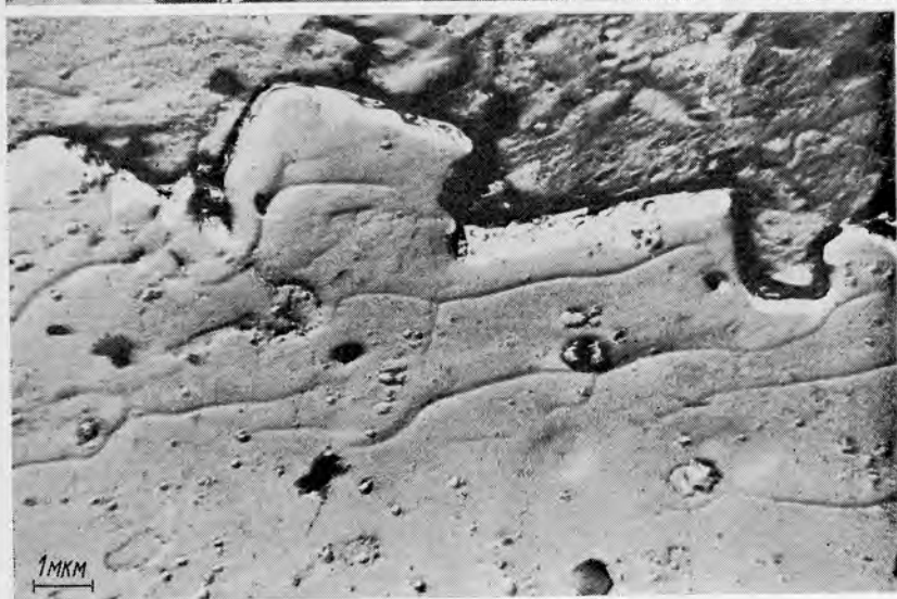
Рис. 1.17. Кристаллы изотропизированного коффинита. Электронное микрофото аншлифа, протравленного азотной кислотой
