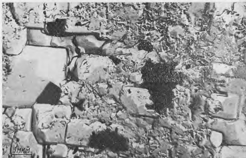
Рис. 2.16. Гармотом с включениями пирита (1) и урановых минералов — предположительно уранинита (2) и коффинита (3). Электронное микрофото
