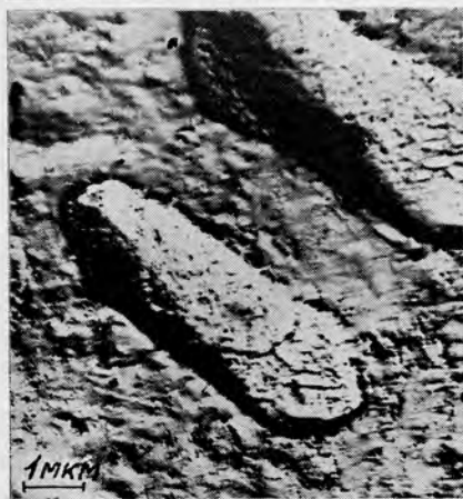
Рис. 1.13. Минераграфические признаки ориентировки зерен синтетических и природных окислов урана (видны ямки травления на полированной поверхности спеченной двуокиси урана)
