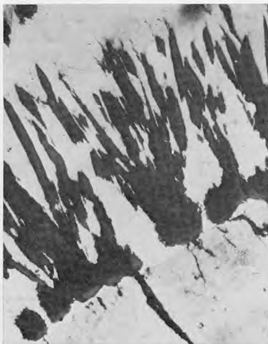
Рис. 3.26. Переход дендритового никелина \text{NiAs} в почковидно-зональную корку. Зональность почек подчеркивается распределением в них мелких сферолитов настурана (микрофото аншлифа)
