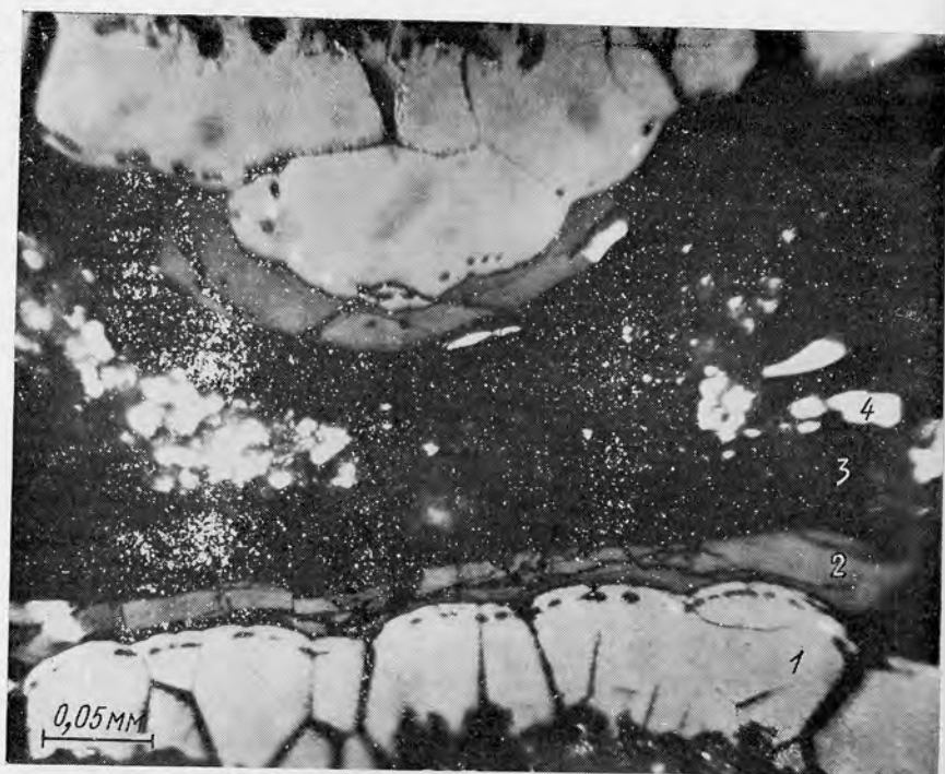
Рис. 4.11. Почковидные корки настурана III с включениями (одновременное отложение) иордизита в приповерхностной зоне сферолитов (микрофото аншлифа) 1 — настуран; 2 — иордизит; 3 — кальцит; 4 — пирит
