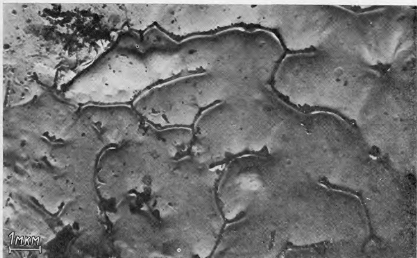
Рис. 3.35. Корковая структура наиболее полимеризованного битума. (электронное микрофото)
