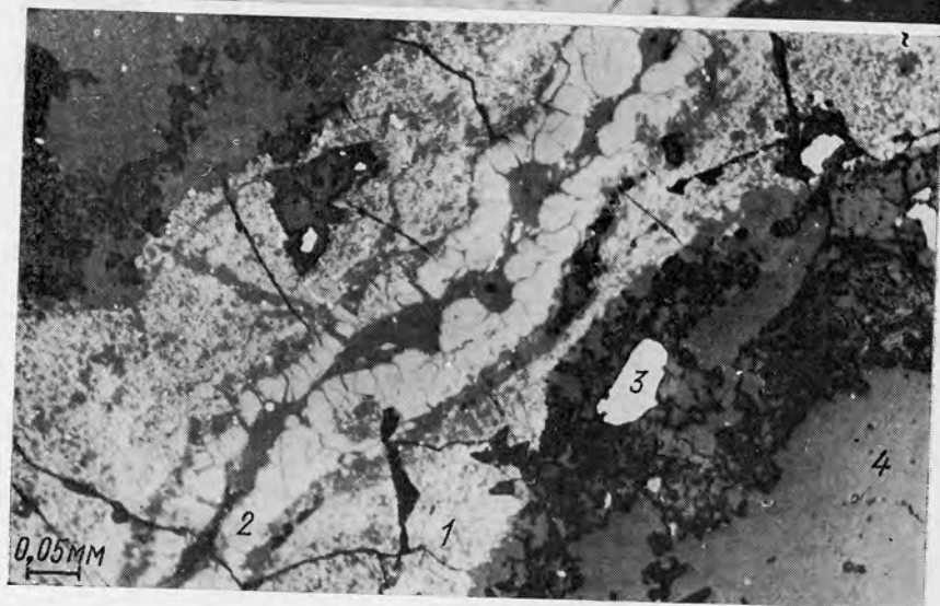
Рис. 4.7. Колломорфная корка молибденита с включениями мелкосферолитового наустрана II (микрофото):
