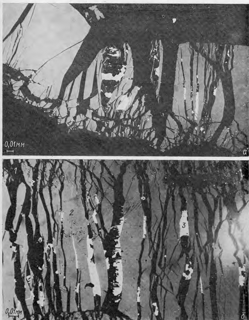
Рис. 4.39. Развитие кварц-карбонатных параллельно-шестоватых прожилков (1) в настурановой корке (2) по системе трещин, перпендикулярных зальбандам, и последующее замещение карбоната этих прожилков галени- том и халькопиритом (3):
