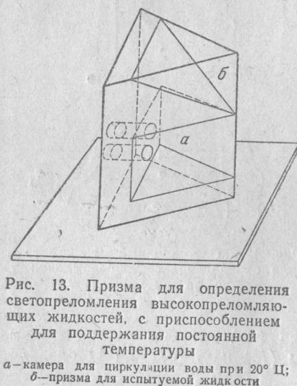
Рис. 13. Призма для определения светопреломления высокопреломляющих жидкостей, с приспособлением для поддержания постоянной температуры
