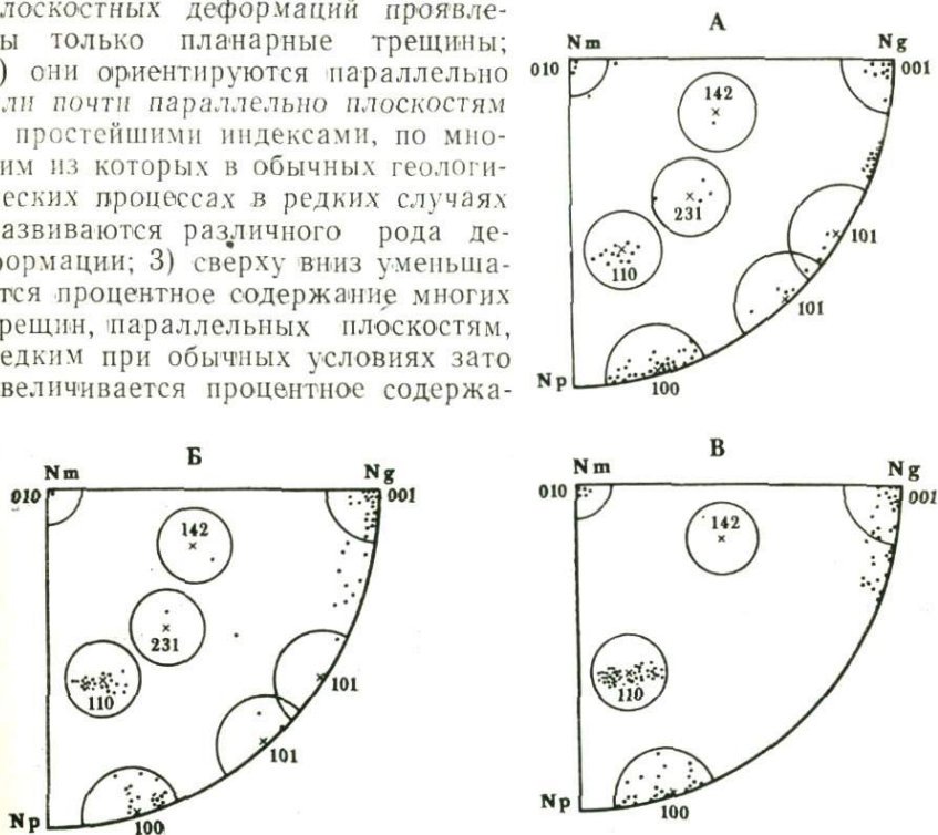
Рис. VI-13. Распределение полюсов планарных трещин в амфиболе. Глубины: А — 72—100 м; Б — 331—373 м; В — глубина 590—614 м
