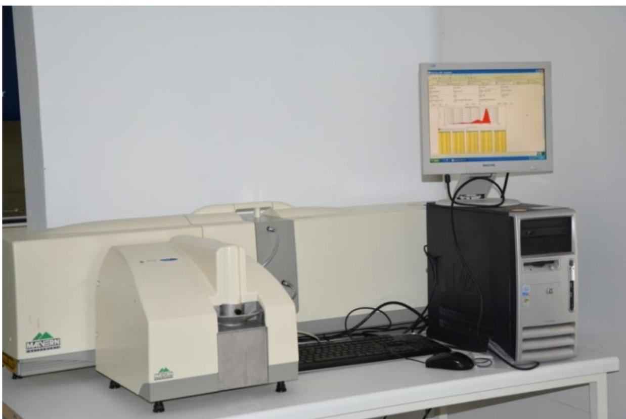
Рисунок 2.9 - Лазерный дифракционный анализатор Mastersizer 2000
