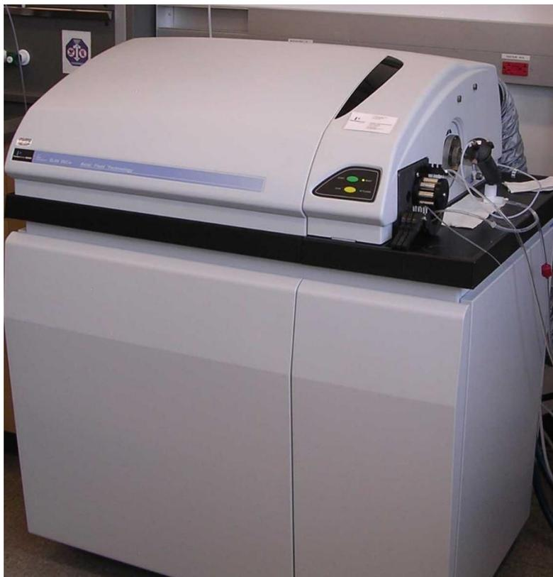
Рисунок 2.7 - Масс-спектрометр с индуктивно-связанной плазмой ELAN-6100 DRC
