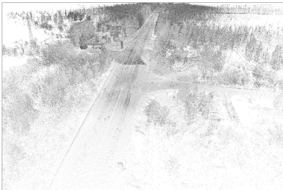
Рис. 2. Единая точечная модель, полученная в результате сканирования автомобильной дороги
