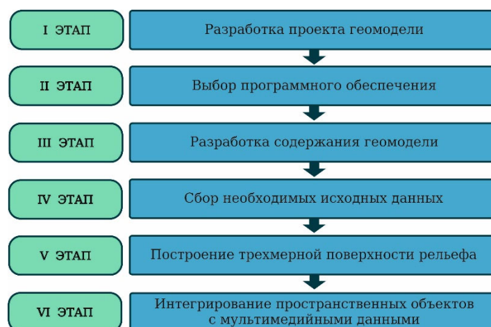
Рис. 3 Технологическая схемасоздания мультимедийной геомодели
