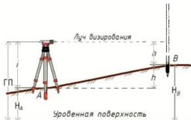
Рис. 3.2. Геометрическое нивелирование способом «вперед»
