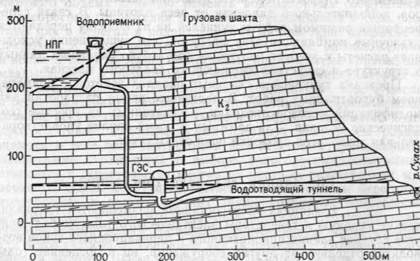
Рис. 1.11. Разрез по трассе водопроводящих сооружений, Чиркейская ГЭС с подземным машинным залом. По Н. И. Кириченко [1962]
