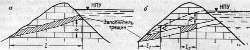
Рис. 3.11. Влияние распределения заполнителя в трещинах на величину гидравлического градиента. По А. Г. Лыкошину.
