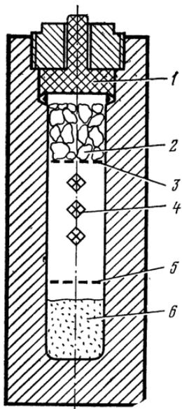
Рис. 14. Схема автоклава для выращивания граната по гидротермальному способу
