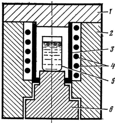
Рис. 15. Схема печи для выращивания граната из раствора в расплаве
