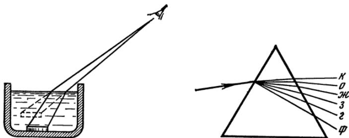
Рис. 7. Схема преломления света в воде
