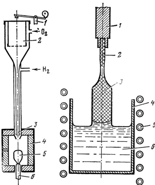
Рис. 16. Схема установки Вернейля
