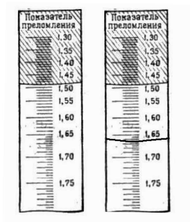
а – тень от однопреломляющего вещества; б – тень от двупреломляющего вещества
