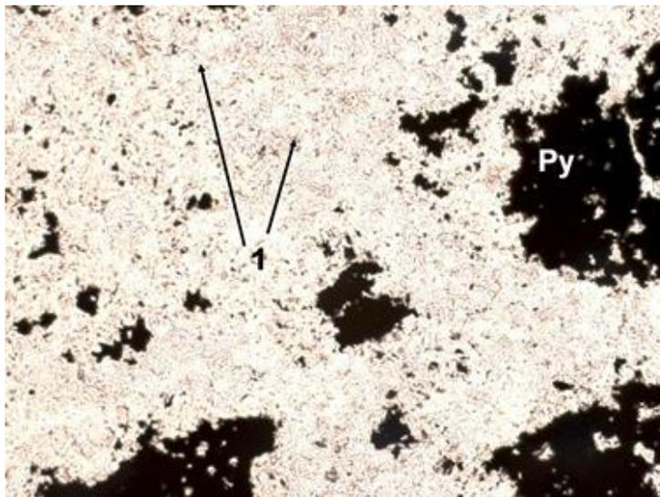
Рисунок 3.19 – Серицит-кварцевый метасоматит, шлиф № 11. В серицитовой (1) микрочешуйчатой основной ткани зерна пирита неправильной, деформированной, угловатой и корродированной формы в агрегатных скоплениях.
