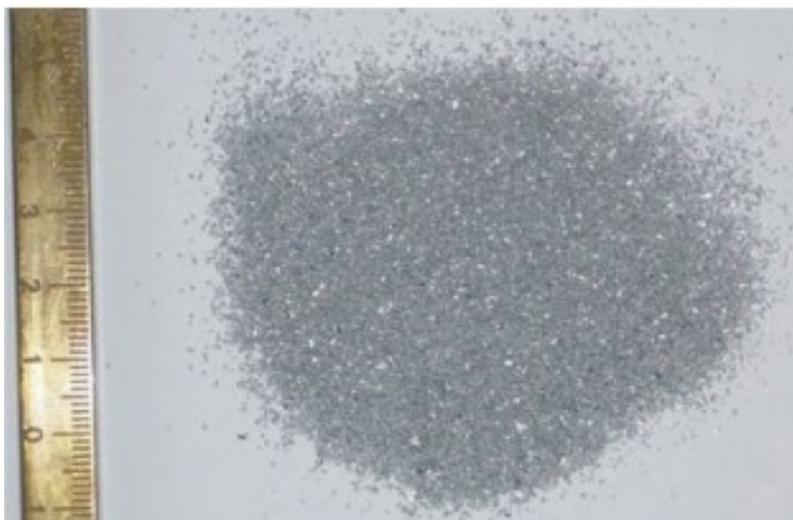
**Рис. 33.** Порошок алюминия GRANAL85 производитель Chr. Otto Pape GmbH
