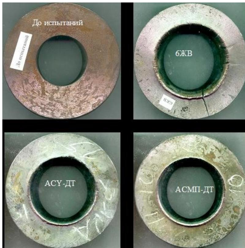
**Рис. 11.** Относительная работоспособность испытуемых смесей по методу расширения стального кольца в трубах диаметром 50 мм в сравнении с аммонитом 6ЖВ
