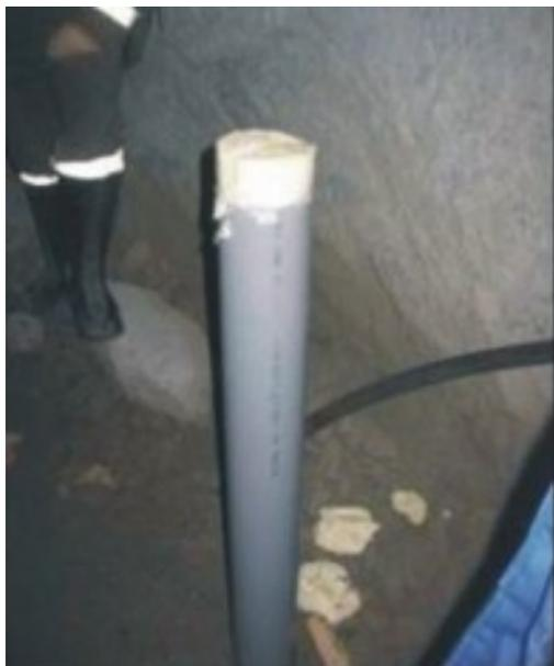
**Рис. 37.** Увеличение колонки заряда ЭВВ «Сабтэк» в процессе газификации
