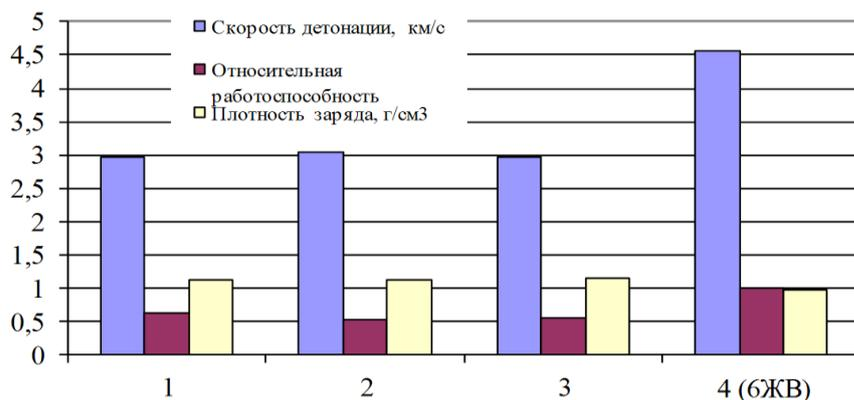
**Рис. 22.** Скорость детонации и работоспособность гранулитов АС-8 для различных поставляемых партий и их сравнение с аммонитом 6ЖВ
