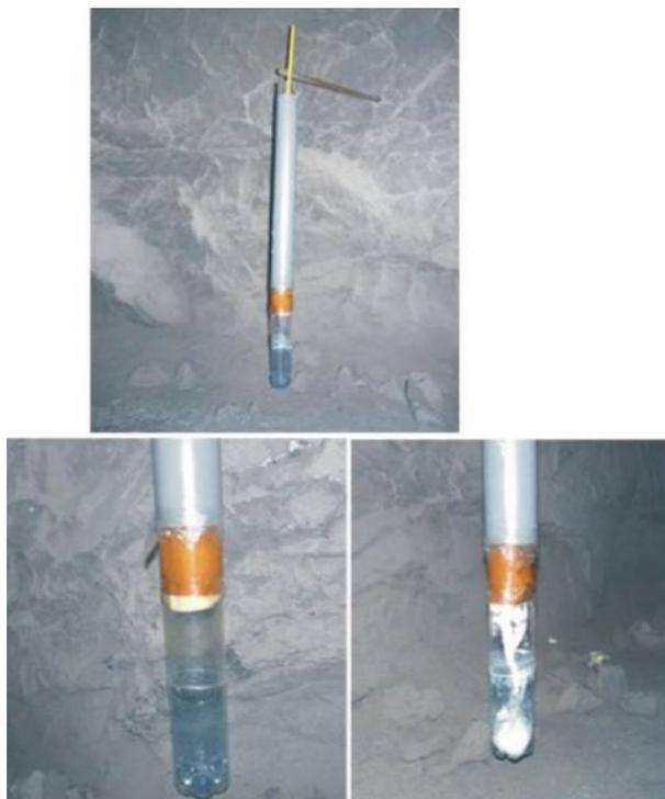
**Рис. 39.** Характер протекания процесса газификации эмульсии в верхней и нижней частях макетного заряда
