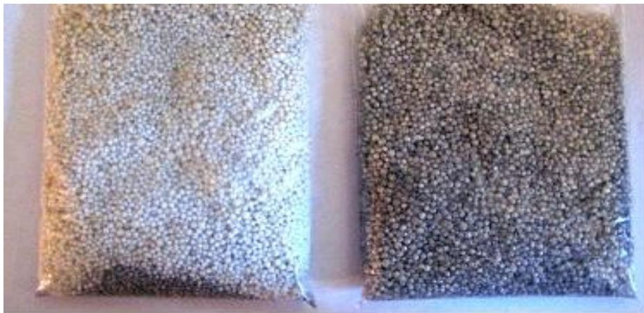
**Рис. 27.** Распределение порошка алюминия в гранулитах при использовании селитр Yara и марки МП
