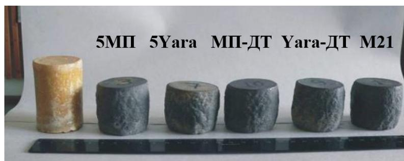
**Рис. 32.** Внешний вид свинцовых столбиков до и после взрыва зарядов ВВ
