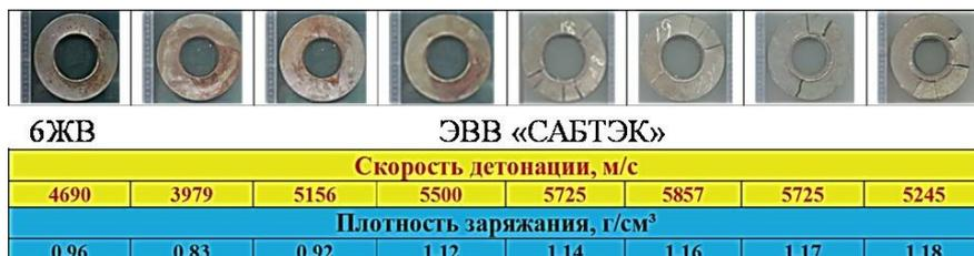
Рис. 52. Бризантность ЭВВ «Сабтэк» в зависимости от скорости детонации и плотности заряжания
