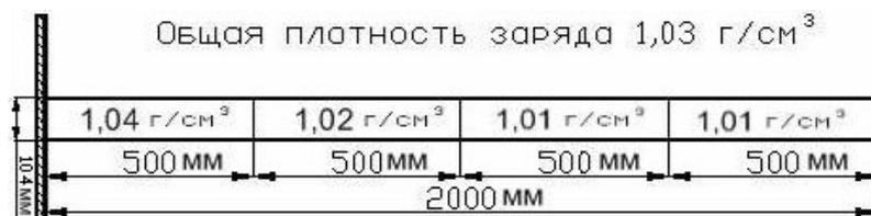
**Рис. 43.** Изменение плотности ЭВВ по колонке заряда в разборном макете (полиэтиленовая труба длиной 2 м)
