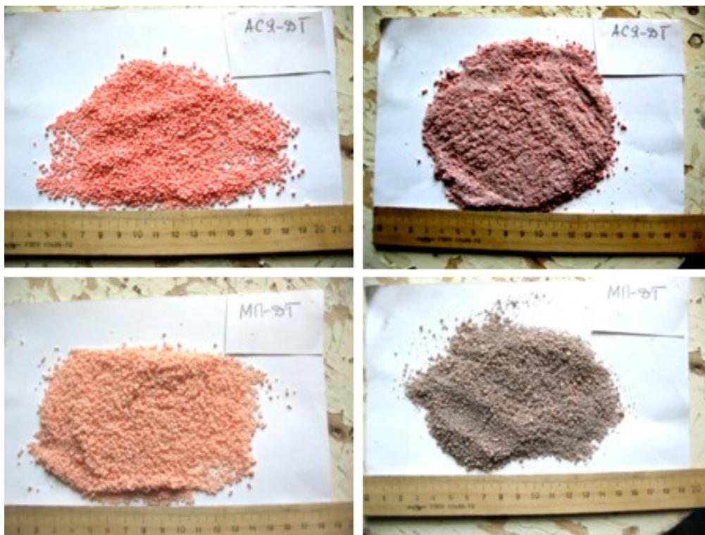
**Рис. 6.** Фотографии смесей АС-ДТ после пневмозаряжания: сверху — селитра фирмы Yara AB; снизу — селитра марки МП
