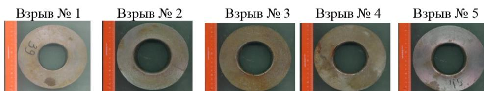
Рис. 71. Характер деформирования стальных колец при взрывании труб при различных условиях динамического нагружения
