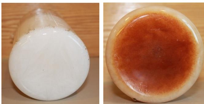
**Рис. 66.** Осадок, выпадающий при кристаллизации раствора окислителя, приготовленного с использованием образца селитры № 2 и вид закристаллизовавшегося раствора окислителя, приготовленного с использованием образца селитры № 1
