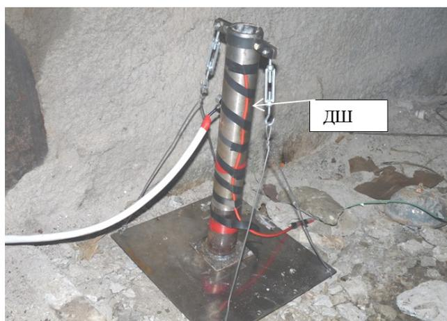
**Рис. 70.** Общий вид установки при испытаниях динамического воздействия взрыва на заряд ЭВВ
