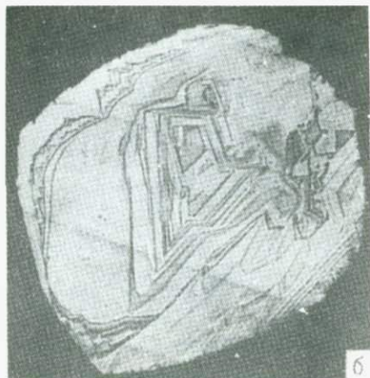
Рис.122. Кристалл № 123. б-фигура травления по- верхности (110). Увели- чение 40\times .
