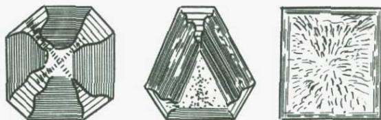
Рис. 1. Внутренние структуры синтетических алмазов по [6].
