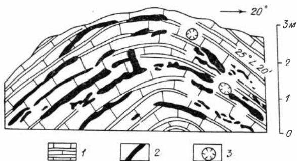
Рис. 3. Схема размещения стратиформных рудных тел. 1 — окварцованные известняки; 2 — антимонитовые рудные тела; 3 — мпиролитовые полости с кристаллами антимонита.
