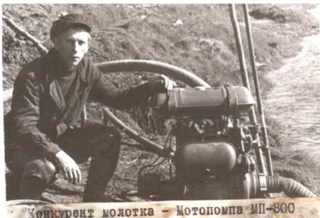
Рис.40. Мотопомпа МП-800, примененная для размыва костеносного слоя. Берелех, 1970 г. Фото из личного архива П.А. Лазарева (дополнение к приложению №1, ф. 37-й, д.37.6).
