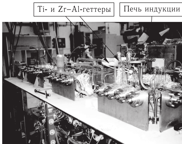
Рис. 7.1. Система выделения и очистки благородных газов. На заднем плане видна индукционная печь (см. также рисунки 7.2 и 7.3)
