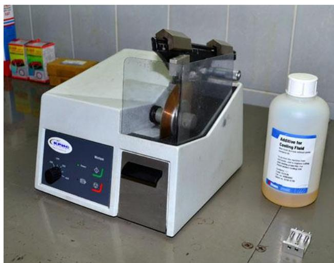
Рисунок 16 - Станок отрезной высокоточный Minitom производства компании «Struers» (Дания)
