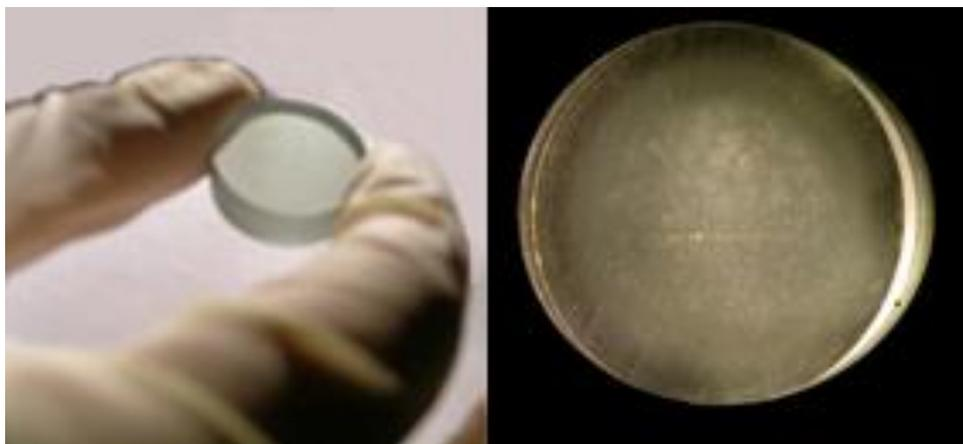
Рисунок 20 - Шайба с образцами для измерений на SHRIMP-II [32]
