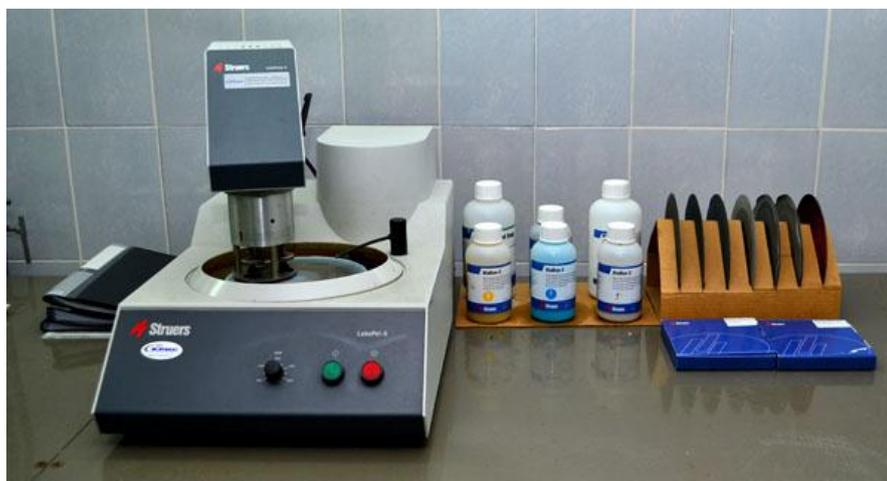
Рисунок 17 - Станок шлифовально-полировальный LaboPol-5 с устройством для автоматической шлифовки и полировки образцов LaboForce-3
