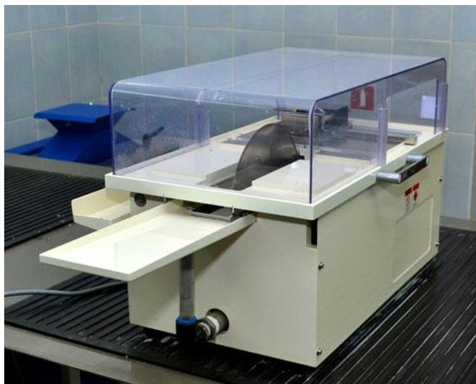
Рисунок 15 - Станок отрезной минералогический МС-120 производства компании «Maruta» (Япония)
