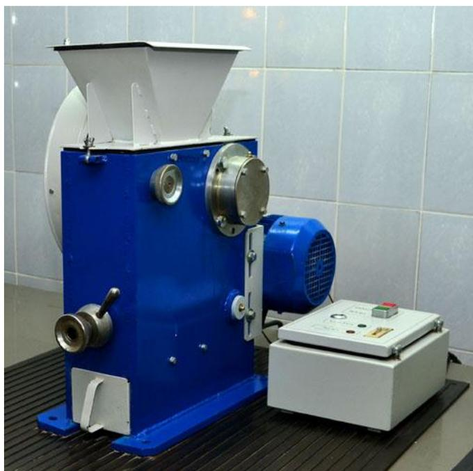
Рисунок 13 - Дробилка щековая ЩД 6
