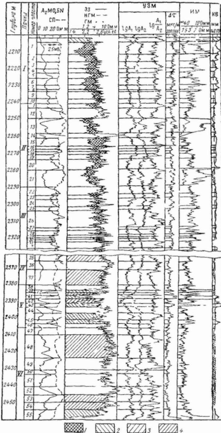
**Рис 41 Выделение коллекторов по комплексно-геофизическим методам в трещинно-кавернозном разрезе (сква 154 месторождения Карабулак-Ачалаки)**
