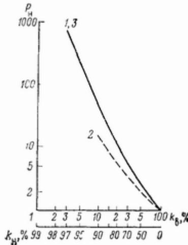
**Рис 74. Зависимость параметра насыщения  $P_n$  от коэффициентов водонефтенасыщения  $k_b$  и  $k_n$ .**
