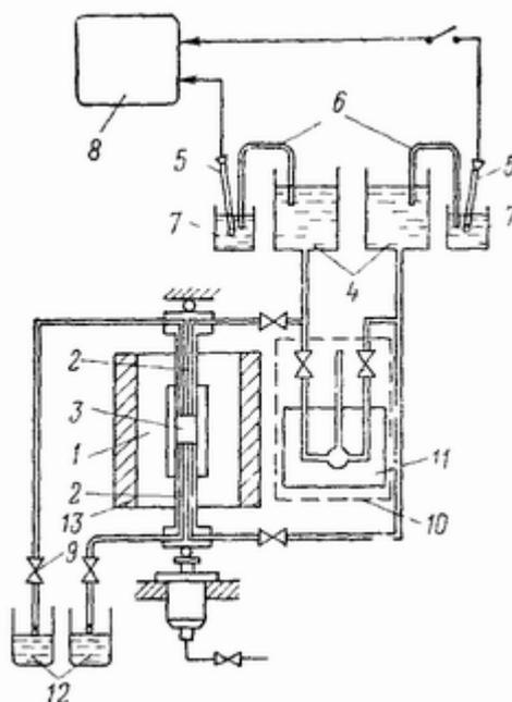
**Рис 27** Схема для изучения влияния глубинных условий на диффузионно-адсорбционную активность пород.
