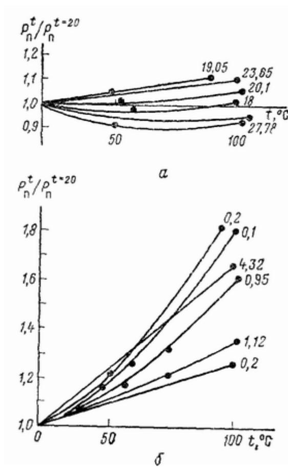
**Рис. 25 Влияние температуры на относительное изменение параметра пористости  $P_n^t / P_n^{t=20}$  карбонатных пород при  $\sigma=150$  кгс/см<sup>2</sup> и  $\sigma=100$  кгс/см<sup>2</sup>. Шифр кривых — коэффициент диффузионно-адсорбционной активности Аая.**
