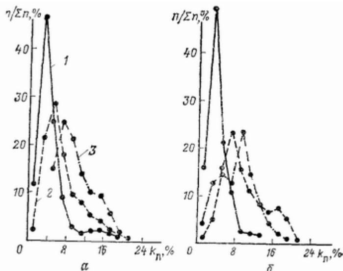
**Рис 43 Кривые распределения коэффициентов пористостей, определенных по керну и по НГМ**
