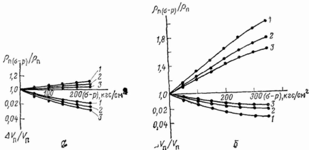
**Рис 23** Пример экспериментальных кривых изменения электрического сопротивления  $\rho_{п(0-p)}/\rho_{п}$  и объемов порового пространства  $\Delta V_{п}/V_{п}$  при  $p=100 \text{ Кгс/см}^2 = \text{const}$  и  $t=20^\circ \text{C}$
