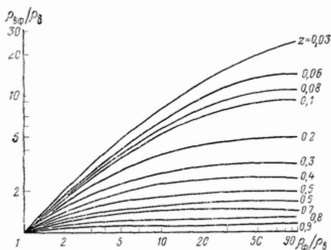
**Рис 67 Зависимости  $\rho_{вф}/\rho_{в} = \rho(\rho_{ф}/\rho_{в})$  для различных значений факторов смешения  $z$**
