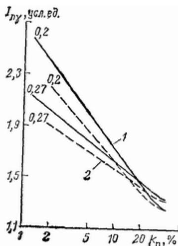
**Рис 52** Зависимость интенсивности  $I_{лу}$  (в эталонированных стандартных единицах) от коэффициента пористости  $k_p$  известняков (1) и доломитов (2) Белоруссии по данным [58]  $Q_c = Q_v = 0.05$  Ом, шифр кривых—диаметр скважины в м
