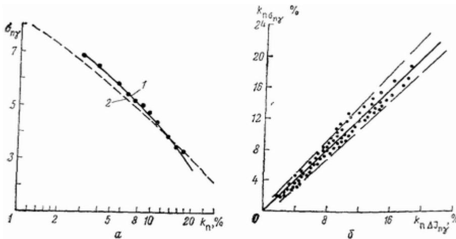
**Рис 54 Зависимость показаний  $I_{пг}$  в единицах  $\sigma_{пг}$  от коэффициента пористости  $k_{п}$  (а) и сопоставление коэффициентов пористости, определенных по НГМ статистическим методом  $k_{п\text{ НГМ}}$  и методом двух опорных горизонтов  $k_{п\text{ керн}}$  (б)**
