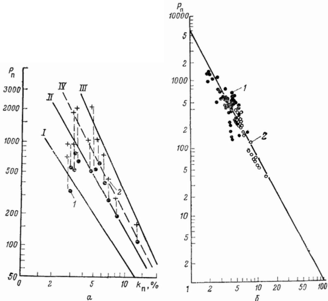
Рис 16 Зависимость параметра по ристости  $P_n$  от коэффициента пористости  $k_n$
