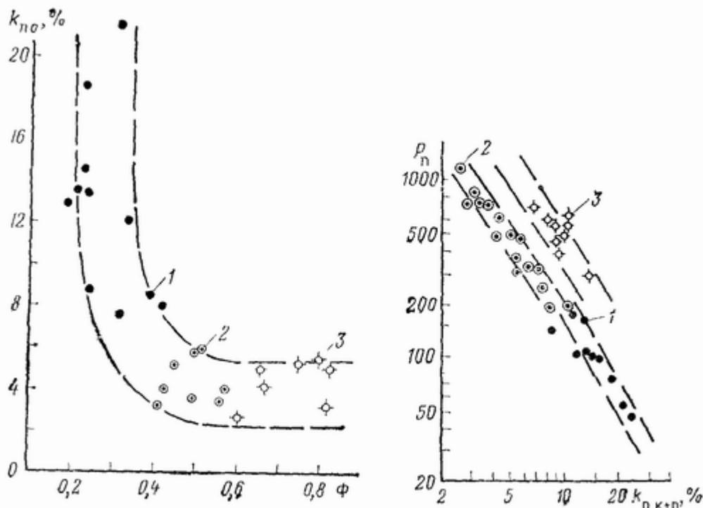
**Рис 13 .Сопоставление коэффициента открытой пористости  $k_{по}$  с параметром формы пор  $\Phi$**
