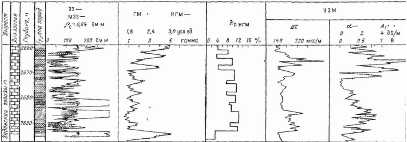
**Рис 35 Выделение коллекторов по комплексу микроэкранированного и экранированного зондов (скв 87 месторождения Осташковичи)**
