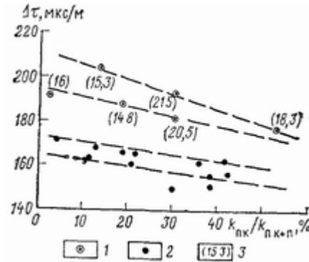
**Рис. 57. Сопоставление интервального времени пробега упругой волны  $\Delta\tau$  с долей кавернозности  $k_{пк}/k_{пк+п}$  образцов пород.**
