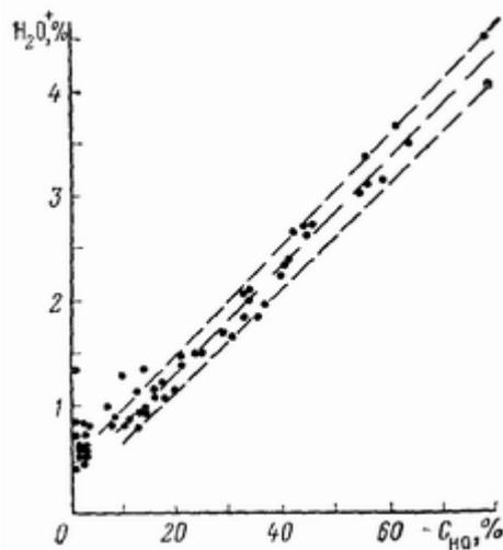
**Рис 51** Зависимость содержания химически связанной воды  $H_2O+$  в породе от величины нерастворимого остатка  $C_{но}$  по данным анализов керна (БССР, межсолевые отложения)
