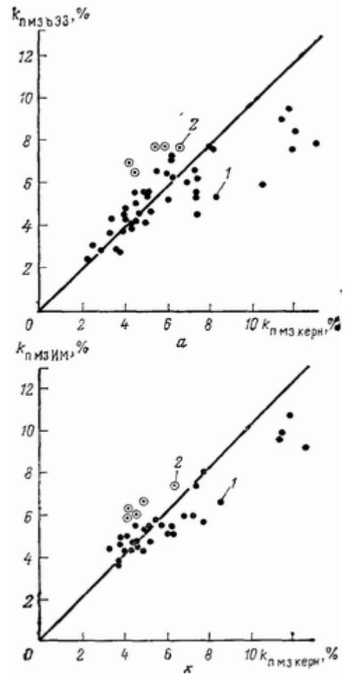
**Рис 62. Сопоставление величин межзерновой пористости  $k_{п мз}$  трещинно-кавер-нозной породы, определенных по керну и удельному сопротивлению (а) и по индукционному методу и керну (б).**
