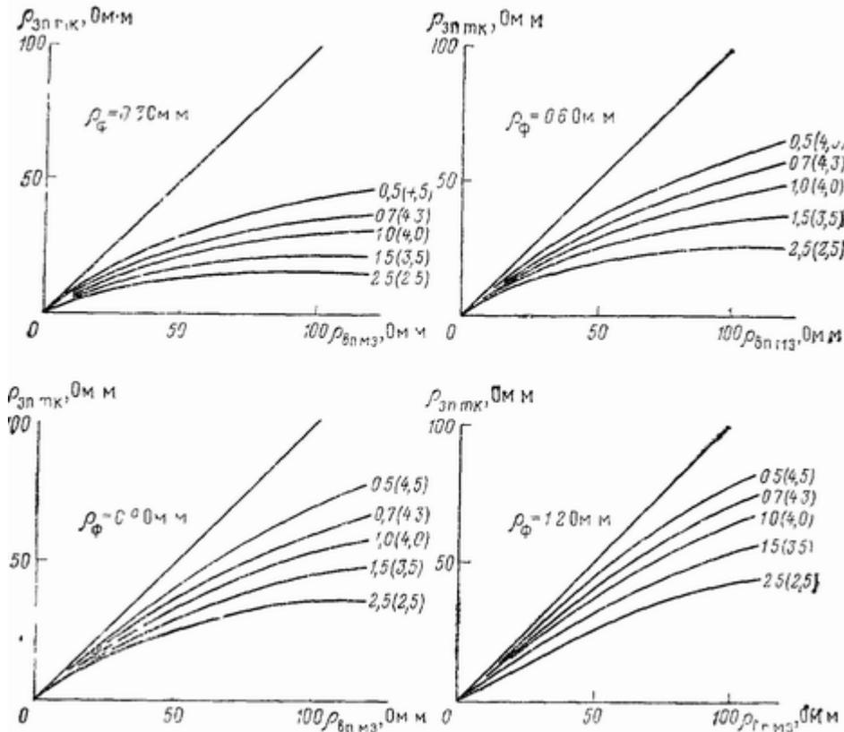
Рис 61. Сопоставление удельного сопротивления  $\rho_{вп\ мз}$  водонасыщенного блока с удельным сопротивлением  $\rho_{zn\ тк}$  зоны проникновения трещинно-кавернозной породы Шифр кривых —  $k_{npr}$  и  $(k_{шк})$  в %
