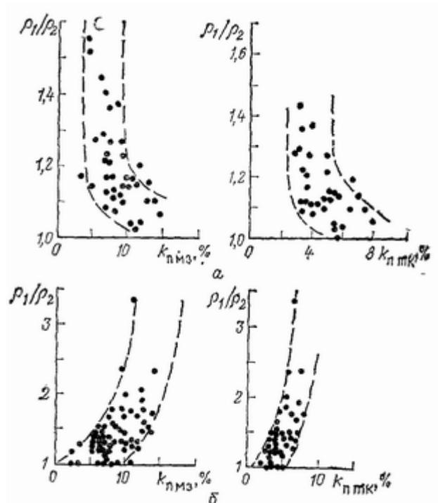
**Рис 31. Сопоставление величины отношения сопротивлений, замеренных при пресном  $\rho_1$  и соленом  $\rho_2$  буровых растворах с величинами трещинно-кавернозной  $k_{пкк}$  и межзерновой  $k_{пмз}$  пористостей карбонатных коллекторов верхнего мела ЧИ АССР.**
