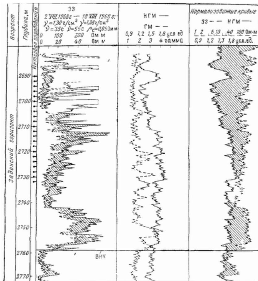
**Рис. 32. Пример выделения карбонатных коллекторов по результатам временных исследований экранированным зондом (скв 30 месторождения Осташковичи).  $Q_H=530$  т/сут,  $\gamma$  — плотность,  $\nu$  — вязкость раствора**
