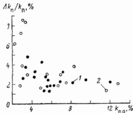
**Рис 22. Сопоставление относительных изменений коэффициента пористости  $\Delta k_n/k_n$  в условиях всестороннего сжатия при  $(\sigma - p)h$  с коэффициентом открытой пористости  $k_{п0}$**
