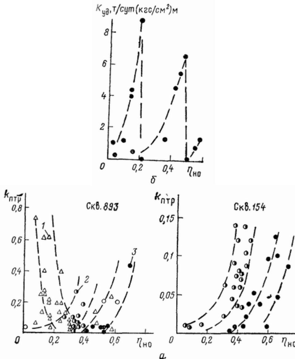
**Рис. 2. Сопоставление трещинной пористости  $k_{птр}$  (а) и удельной продуктивности  $K_{уд}$  (б) с относительным содержанием нерастворимого остатка  $\eta_{но}$  (известняки верхнего мела ЧИ АССР).**
