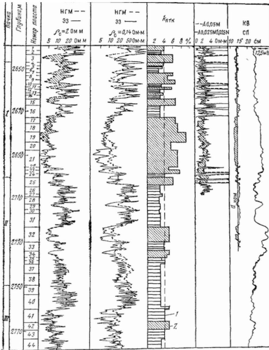
**Рис. 38. Пример выделения коллекторов и разделения их на типы методом нормирования диаграмм  $p_{э,зз}$  и  $I_{пгк}$  по пористости.**
