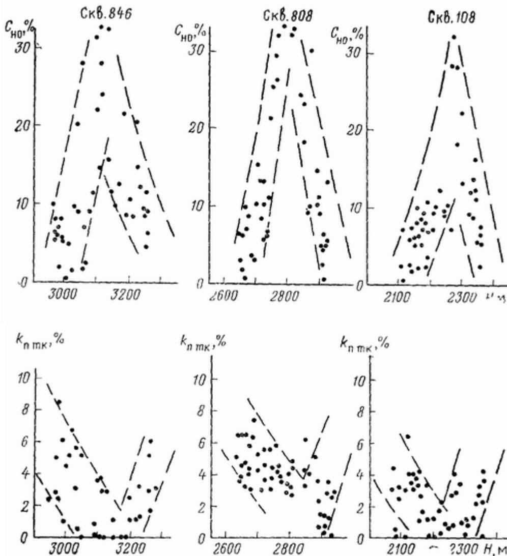
Рис 4 Характер изменения трещинно-кавернозной пористости  $k_{п тк}$  и глинистости  $C_{HO}$  от глубины залегания породы (верхнемеловые известняки ЧИ АССР)
