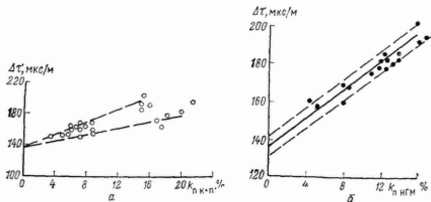
**Рис 56 Сопоставление интервального времени пробега упругой волны  $\Delta\tau$  с коэффициентом пористости  $k_{пк+п}$  для доломитов по данным керна (а) и с  $k_{п НГМ}$  по геофизическим данным (б) [месторождение Осташковичи]**
