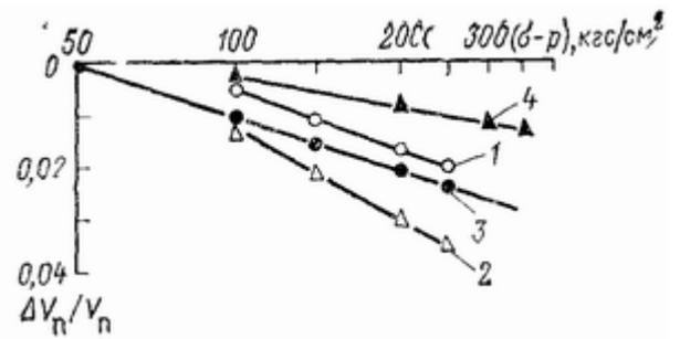
**Рис 19. Относительное изменение объемов порового пространства  $\Delta V_{\text{п}}/V_{\text{п}}$  карбонатных пород в условиях всестороннего сжатия при  $k=100 \text{ кгс/см}^2$  и  $t=20^\circ\text{C}$ .**
