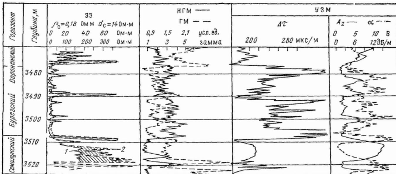
Рис 37. Выделение карбонатных коллекторов и оценка их продуктивности по методу «исследование — испытание — исследование» (скв 10, Барсуковская площадь).
