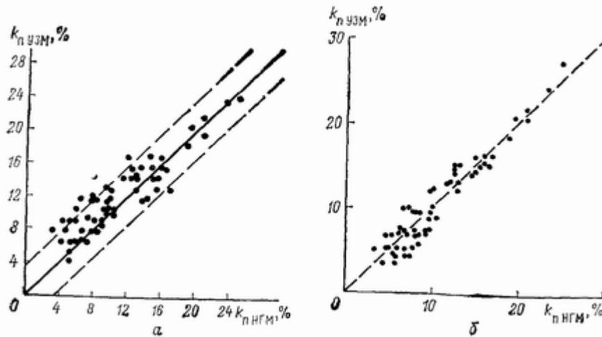
**Рис 58. Сопоставление величин общей пористости, определенных по ультразвуковому и нейтронному гамма-методу.**
