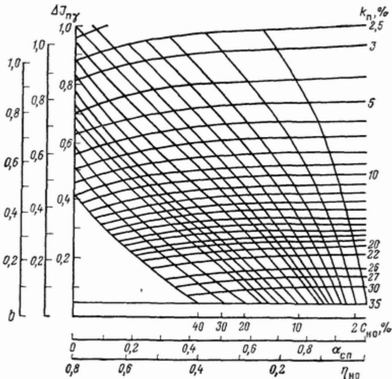
**Рис. 49. Номограмма для определения пористости известняков верхнего мела по данным нейтронного гамма-метода и потенциалов собственной поляризации**
