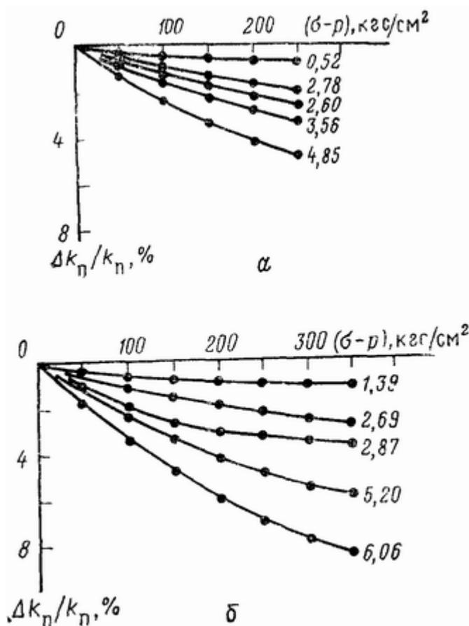
**Рис 21** Примеры кривых относительного изменения коэффициента пористости  $\Delta k_p/k_p$  в зависимости от эффективного напряжения  $(\sigma - \rho)$  при  $P=100 \text{ Кгс/см}^2 = \text{const}$  и  $t=20^\circ\text{C}$
