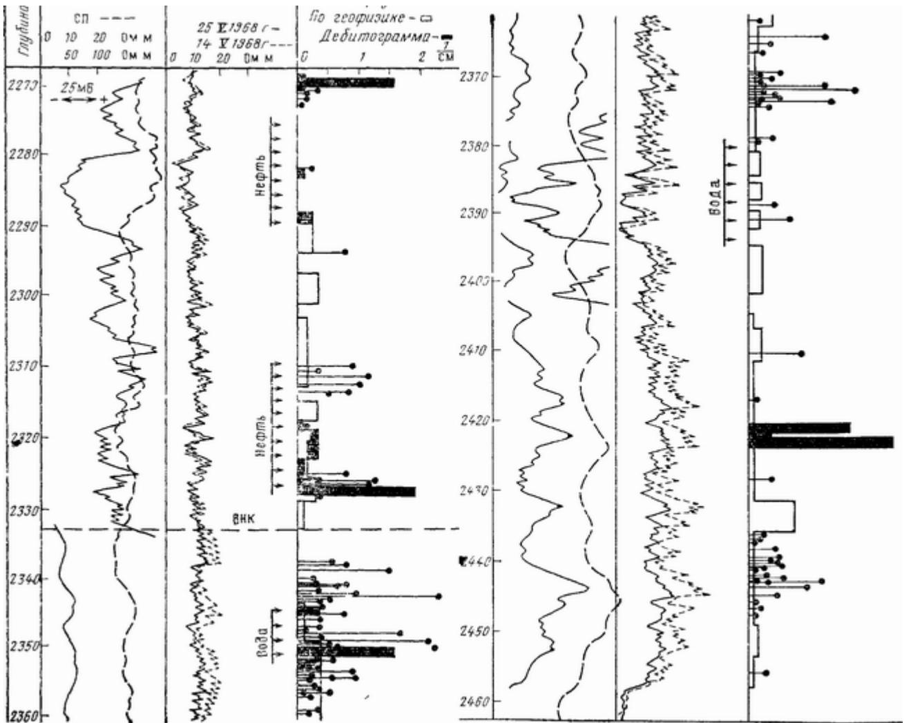
**Рис 71. Определение положения ВНК по изменению кажущегося сопротивления пластов (скв 154 месторождения Карабулак -Ачалуки)**
