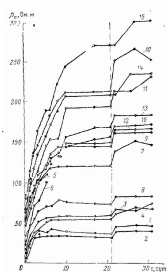
**Рис 65 Изменение удельного сопротивления  $r_p$  кернов в результате диффузии. 1—16 — номера образцов**
