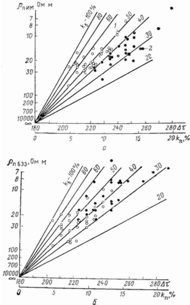
**Рис 72. Сопоставление интервального времени пробега упругой волны  $\Delta\tau$  в известняках верхнего мела ЧИ АССР с их удельным сопротивлением, определенным по индукционному методу  $\rho_{п\text{им}}$  (а) и боковому электрическому зондированию  $\rho_{п\text{БЭЗ}}$  (б)**
