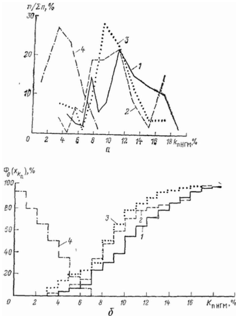
**Рис 36 Кривые распределений коэффициентов пористости  $k_{п НГМ}$  групп пород, выделенных по комплексу микроэкранированного и экранированного зондов (а), и интегральные функции распределений  $\Phi_0(x_{кп})$  этих коэффициентов (б) Месторождение Осташковичи,  $p_v \approx 0,004$  Ом**
