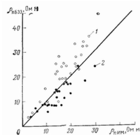
**Рис 73 Сопоставление удельных сопротивлений, определенных по боковому электрическому зондированию  $\rho_n$  БЭЗ и индукционному методу  $\rho_n$  им (скв-154 месторождения Карабулак Ачалуки).**
