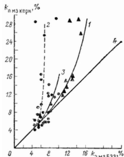
**Рис 64 Сопоставление величин межзерновой пористости, определенных по керну  $k_{\text{п мз керн}}$  и методу сопротивления  $k_{\text{п мз БЭЗ}}$**
