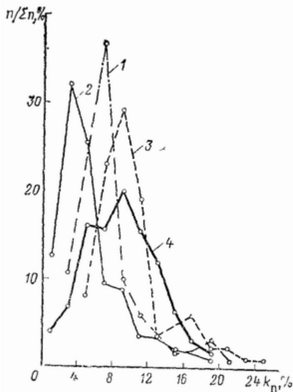
**Рис 12 Кривые распределения коэффициентов пористости для межслоевых отложений месторождения Осташковичи Пористость**
