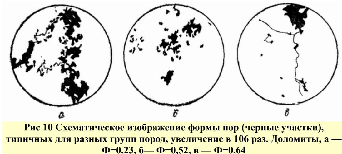
**Рис 10 Схематическое изображение формы пор (черные участки), типичных для разных групп пород, увеличение в 106 раз. Доломиты, а —  $\Phi=0,23$ , б —  $\Phi=0,52$ , в —  $\Phi=0,64$**
