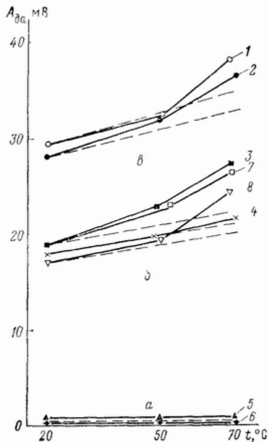
**Рис 29 Влияние температуры  $t$  на диффузионно адсорбционную активность  $A_{ад}$  пород при  $\sigma=25 \text{ кгс/см}^2 = \text{const}$ .**
