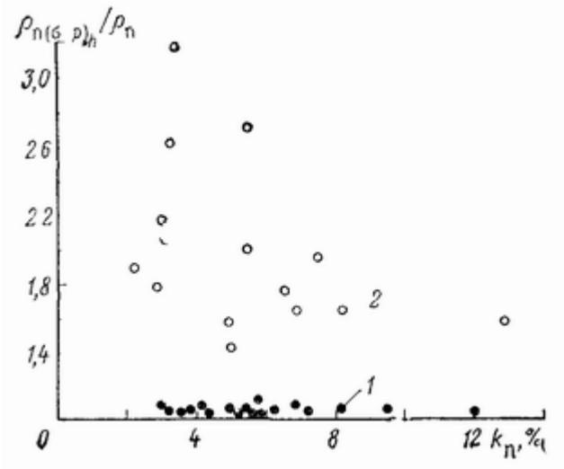
**Рис. 24. Сопоставление относительных значений  $\rho_n(\sigma-p)_h/\rho_n$  с коэффициентом открытой пористости  $k_n$ .**
