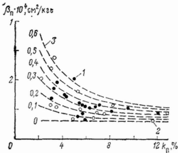
**Рис 20** Сопоставление коэффициентов сжимаемости пор  $\beta_{\pi}$  [при  $(\sigma - p) = 250$  кгс/см<sup>2</sup>] и пористости карбонатных пород  $k_p$  / — верхнемеловые известняки ЧИ АССР 2 — девонские доломиты БССР 3 — теоретические кривые, шифр которых  $k_{п тр}$ , %
