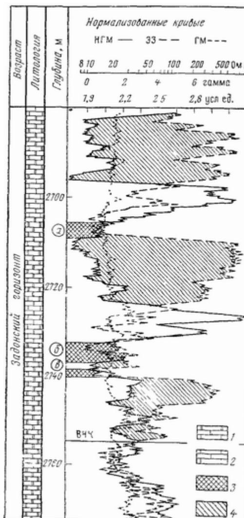
**Рис 39 Нормализованные по пористости кривые нейтронного гамма-метода и экранированного зонда (скв 35 месторождения Осташковичи,  $r_c=0,04$  Омм).**
