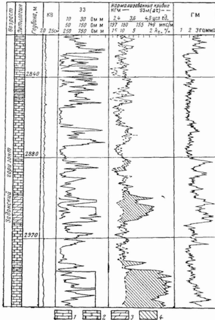
**Рис 69** Пример литологического расчленения карбонатного кавернозно-трещинного разреза по комплексу нормализованных по пористости кривых нейтронного гамма и ультразвукового методов (скв. 34 месторождения Осташковичи, водоносная часть).
