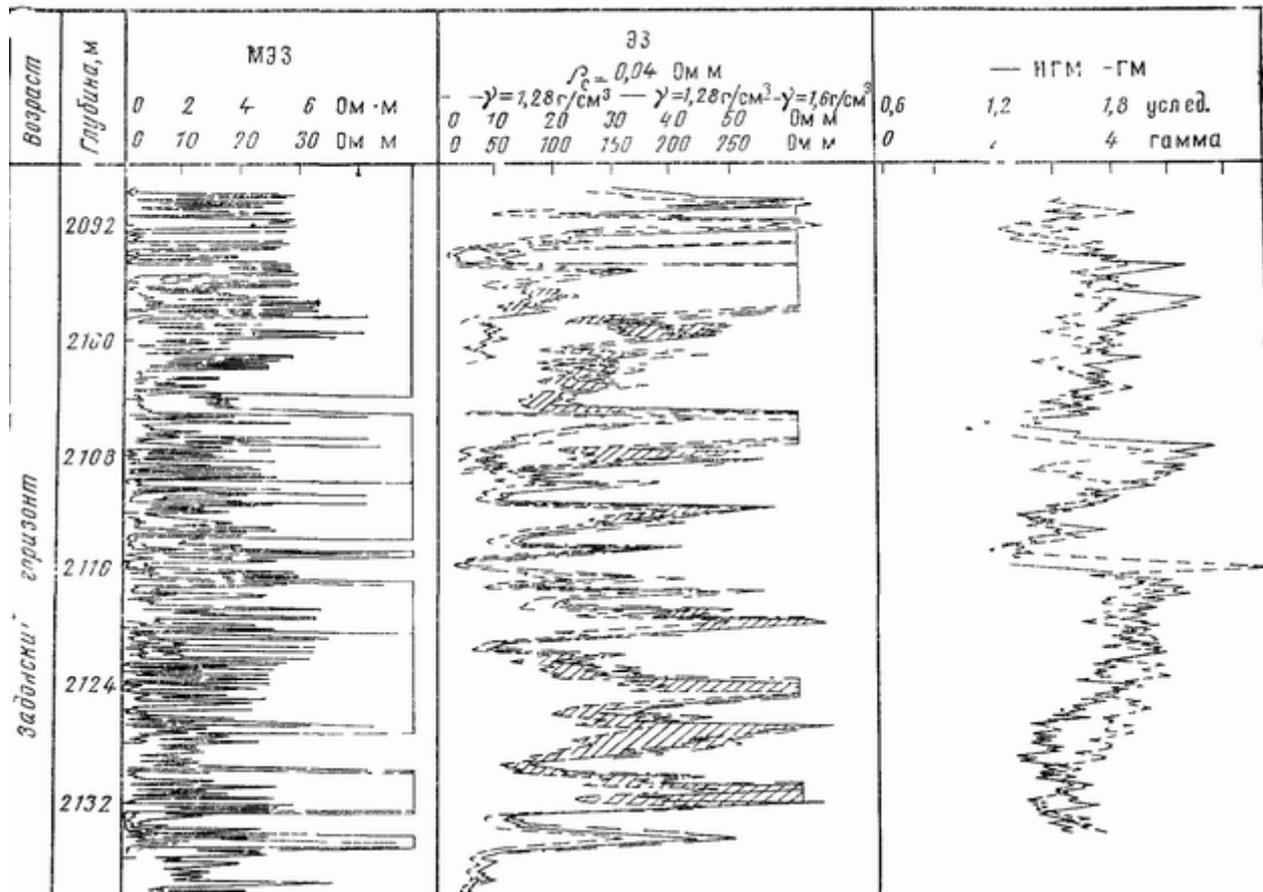
Несмотря на большое разнообразие структурных форм, в целом коллекторы межсолевой толщи, связанные единой системой трещин, по своим фильтрационным и емкостным свойствам ведут себя по результатам геофизических исследований как межзерновые коллекторы со смешанной структурой порового пространства с преобладанием в отдельных интервалах разреза либо каверновой, либо межзерновой емкости в зависимости от сочетания и соотношения структурных форм.
