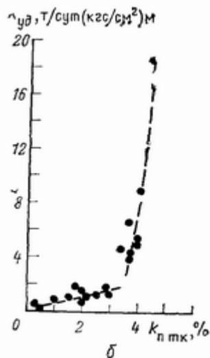
**Рис 76** Связь продуктивности известняков верхнего мела ЧИ АССР с трещинной  $k_{п тр}$  (а) и трещинно-кавернозной  $k_{п тк}$  (б) пористостью
