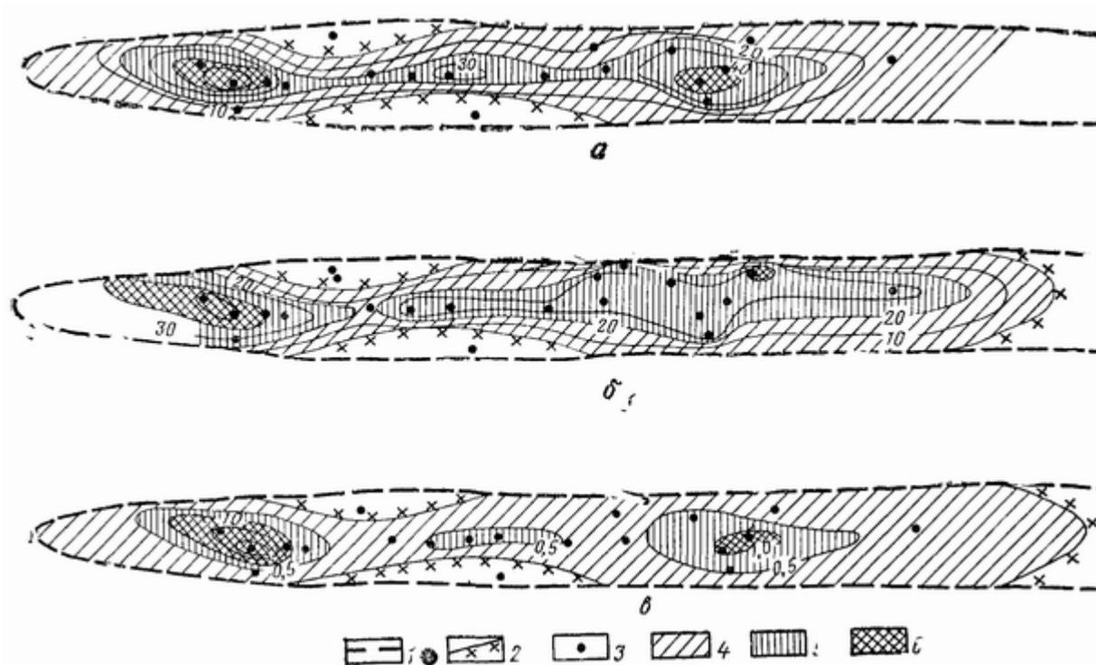
**Рис 77** Карты равных мощностей (а), равного нефтенасыщения (б) и удельного нефтенасыщения (в) для пластов с нефтенасыщенной матрицей по скважинам Малгобек-Вознесенского месторождения
