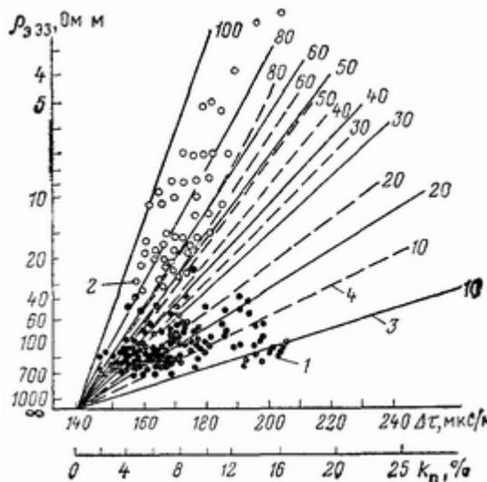
**Рис 75. Сопоставление удельных сопротивлений пород, определенных по экранированному зонду  $\rho_{33}$ , и интервального времени пробега упругой волны  $\Delta\tau$  (месторождение Осташковичи, межсолевые**
