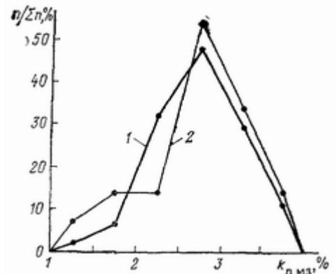
**Рис 50. Статистические распределения межзерновой пористости  $k_p \text{ мз}$ , определенной по БЭЗ (1) и ЭЗ (2) для плотных пород**
