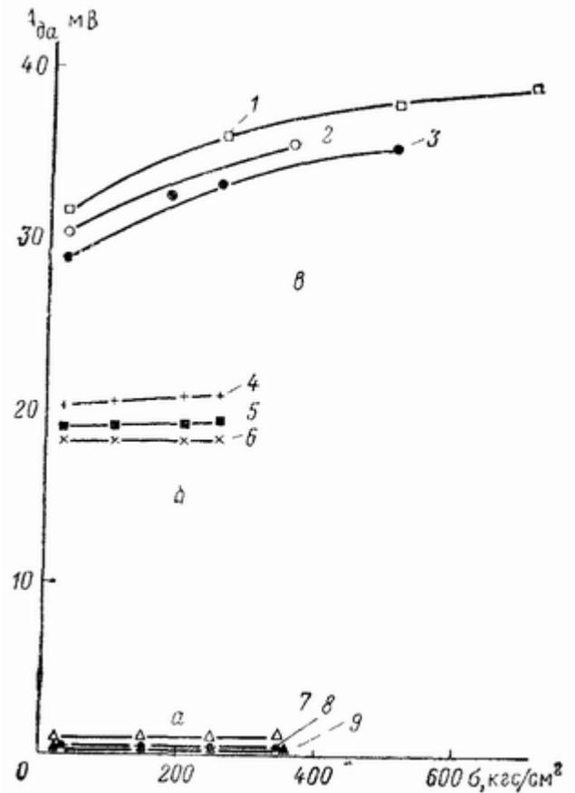
**Рис 28 Влияние всестороннего сжатия  $\sigma$  на диффузионно-адсорбционную активность  $A_{\text{да}}$  пород при  $t=20^{\circ}\text{C}$**
