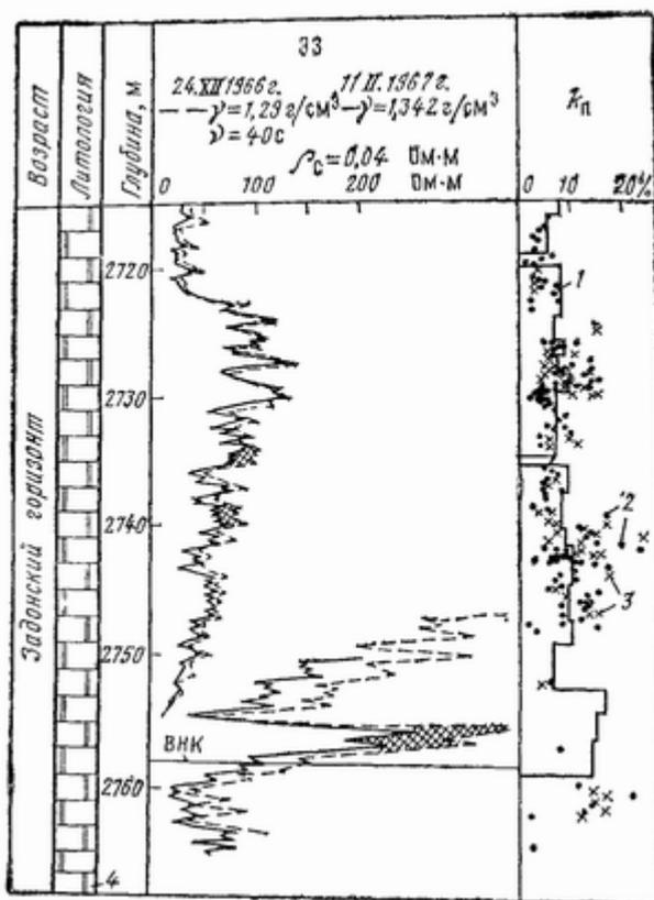
**Рис 33. Временные исследования рэ ээ экранированным зондом (скв. 7 месторождения Осташковичи).**
