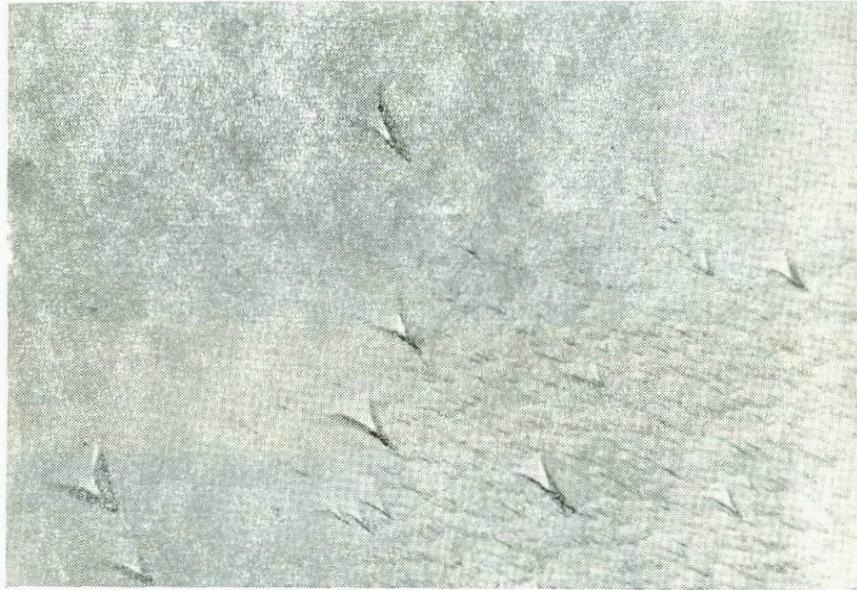
Рис. 37. Структурно-морфологические особенности излома, перпендикулярного к плоскости спайности вольфрамита (обр. 1001 и 50); электрономикроскопические снимки, угольные реплики, ув. 7500 $\times$
