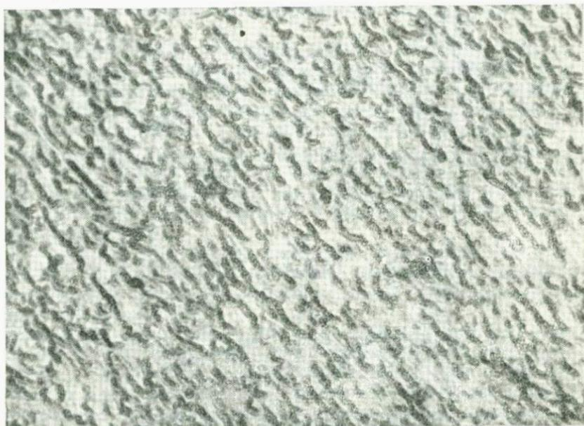
Рис. 32. Электронномикроскопический снимок с излома образца вольфрамита состава 31% MnWO<sub>4</sub>. Угольная реплика. Ув. 15 000×
