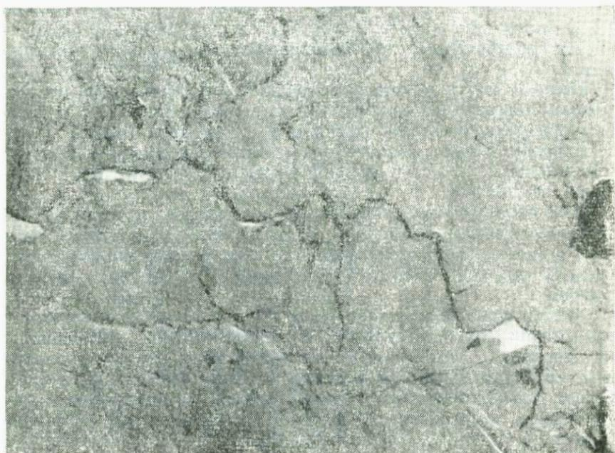
Рис. 25. Электронномикроскопический снимок с излома образца кассiterита, не содержащего tantal и ниобий. Ув. 7500 $\times$
