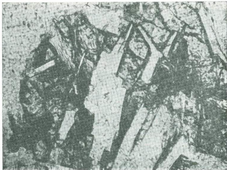
Рис. 23. Долерит с пойкилоофитовой структурой; увел. 170, без анализатора (обр. 20.2.9.1; из коллекции ИГЕМ АН СССР)
