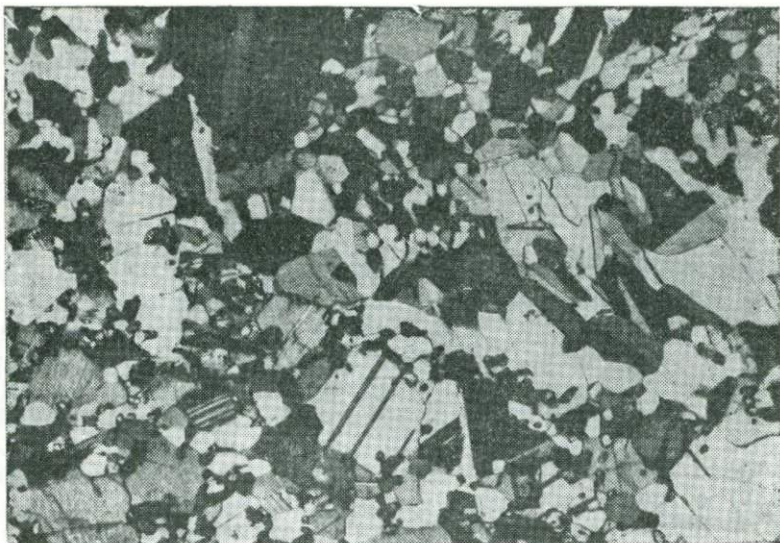
Рис. 32. Анортозит с гранобластовой структурой (обр. 60 619, «Аполлон-16» [28])
