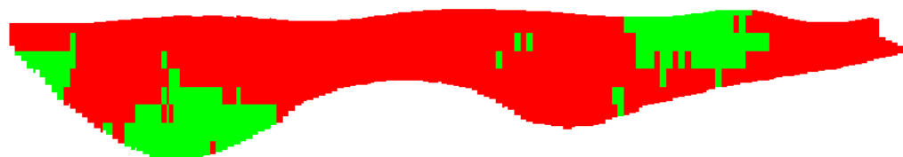
Рис. 5.14. Модель 2-го геологического блока с выделенными областями забалансовых руд.
