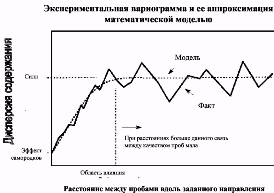
Рис. 2.19. Экспериментальная вариограмма и её аппроксимация сферической моделью
