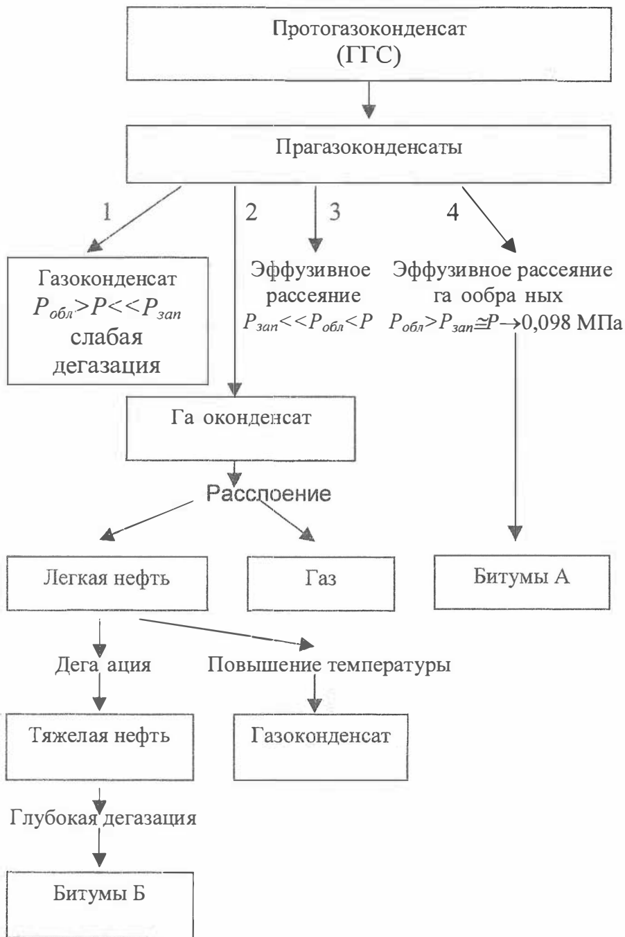
Рис.2.2. Общая схема формирования залежей углеводородов
