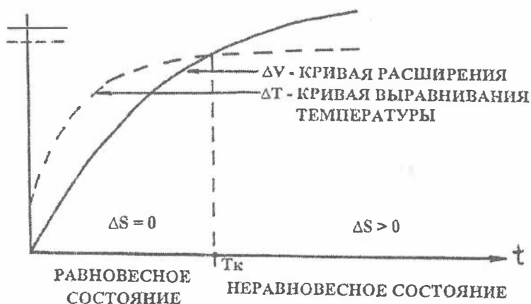
Рис.2.4. Изменение термодинамического состояния системы
