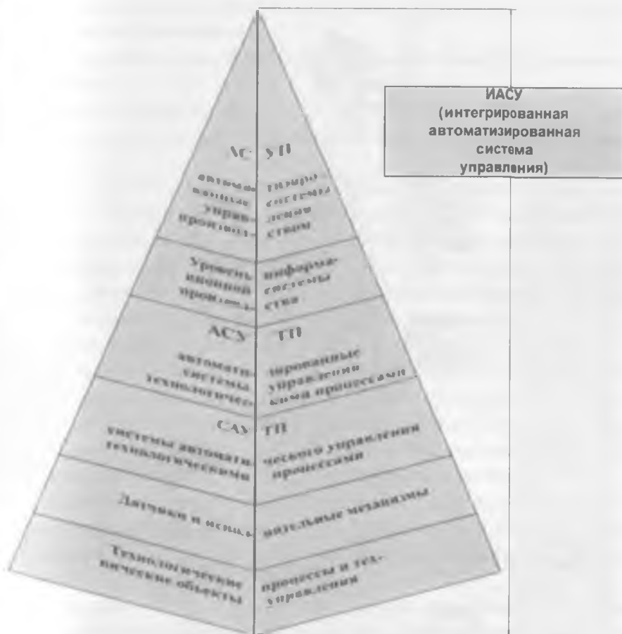
Рис. 1.4. Макроструктура ИАСУ гидрометаллургического завода № 2 Навоийского горно-металлургического комбината
