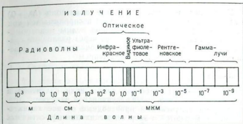
Рис. 1.2. Диапазон спектра электромагнитного излучения
