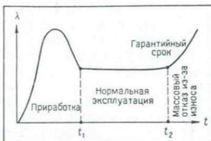
Рис 9.2. Кривая интенсивности отказов элементов
