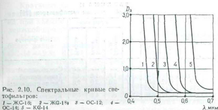
Рис. 2.10. Спектральные кривые светофильтров:
