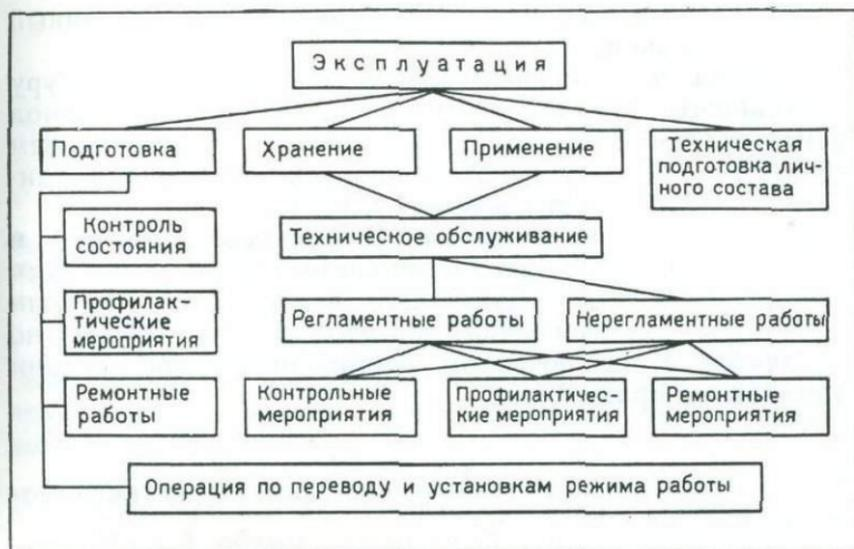
Рис. 9.1. Схема основных терминов и понятий теории эксплуатации
