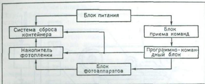
Рис. 3.1. Блок-схема аппаратуры с доставкой фотопленки на Землю
