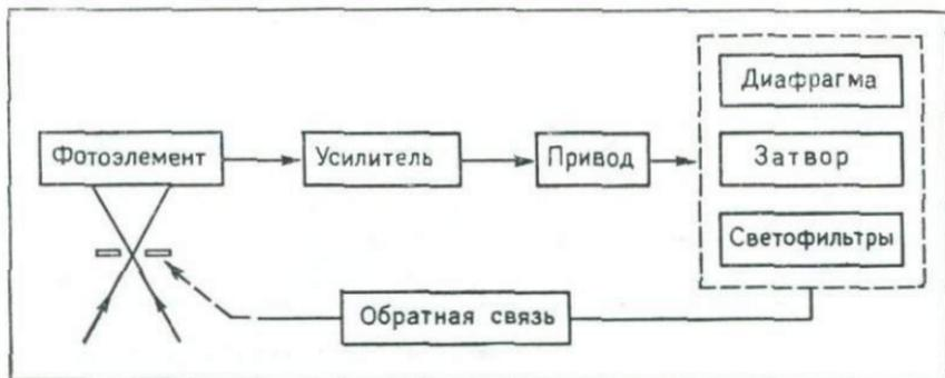
Рис. 3.5. Блок-схема автомата экспозиции
