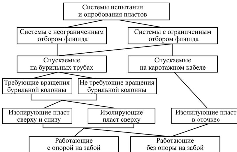
Рис. 8.1. Классификация систем для испытания и опробования пластов
