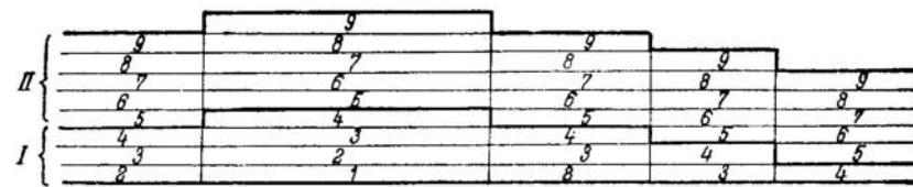
Рис. 19. Схематический разрез вдоль оси  $Z$  через кристалл берилла со ступенчатой гранью пинакоида
