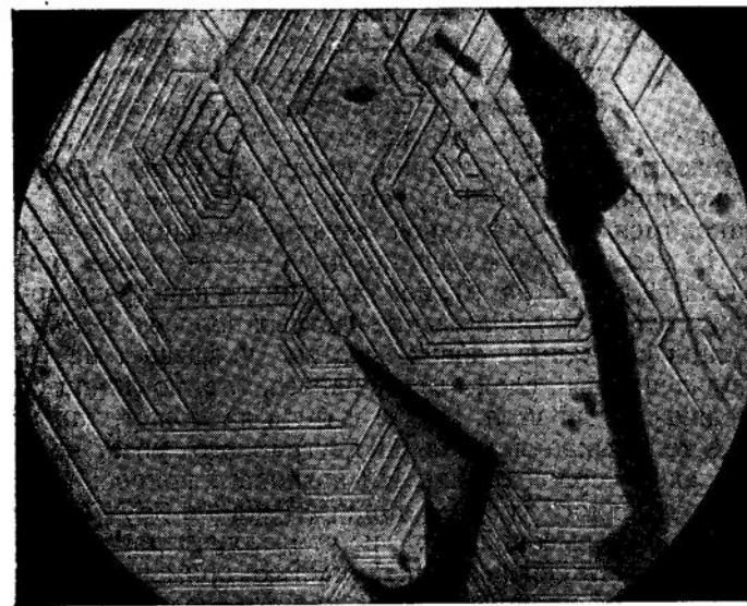
Рис. 32. Срастание систем слоев на грани ступенчатого пинакоида (серые участки). Очертания слоев роста — концентрические черные линии, швы нарастания — одиночные линии, по одну сторону от которых разрастаются зародыши слоев. Микрофотография в отраженном свете. ×56
