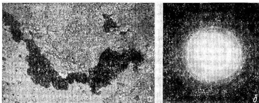
Рис. 61. Электронно-микроскопический снимок кости ископаемой рыбы с выделением кубических кристалликов окисла урана в порах (а, увел. 24 000). На микродифракции (б) — порошкограмма  $\text{UO}_2$
