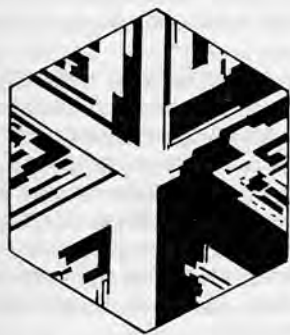
Рис. 2.7. Фигуры травления на базальном сечении двойника по бразильскому закону.
